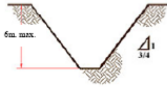
TALUD SIMPLE - GENERAL TIPO DE SUELO A
