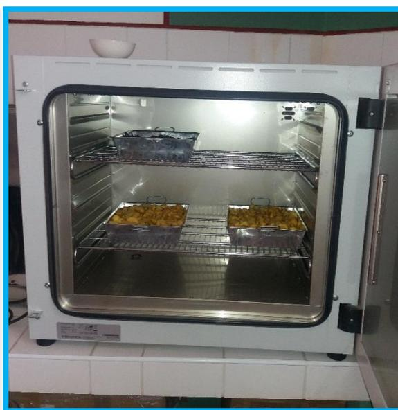
**FOTOS N° 03:** Obtención del extracto acuoso, sometidas a cocción a una temperatura de 60 a 70°C, empleando el agua como liquido extractivo.
