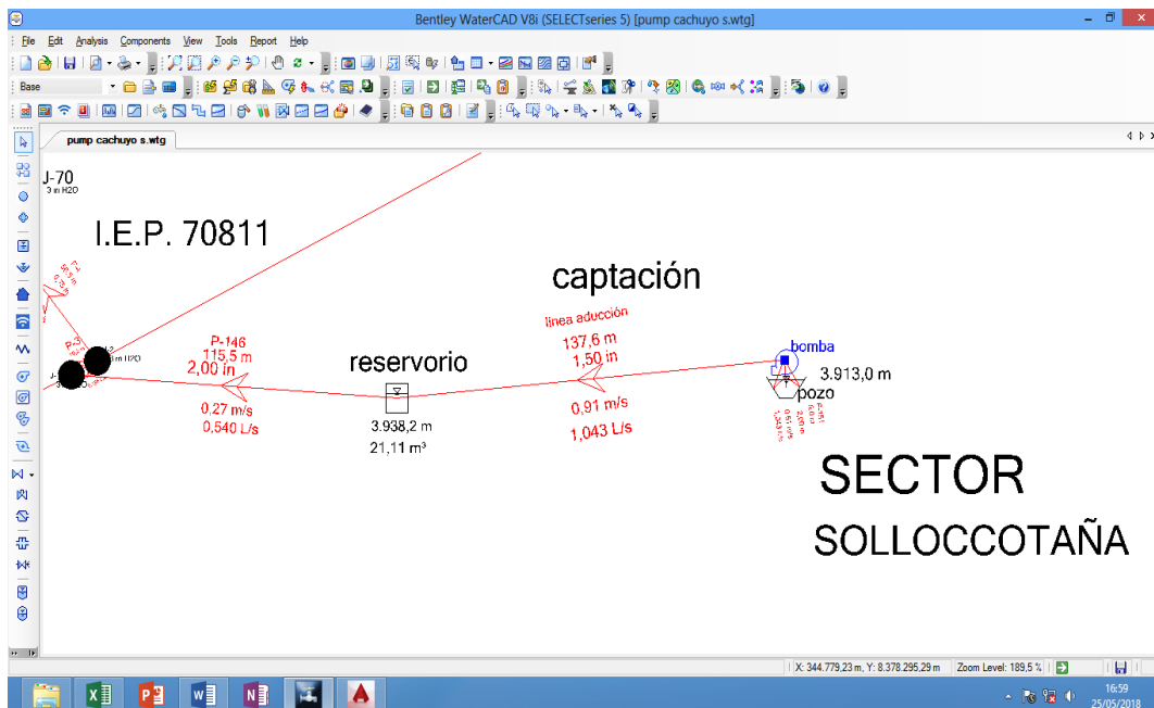
Figura 3.8 Modelamiento hidráulico CAPTACIÓN – RESERVORIO
