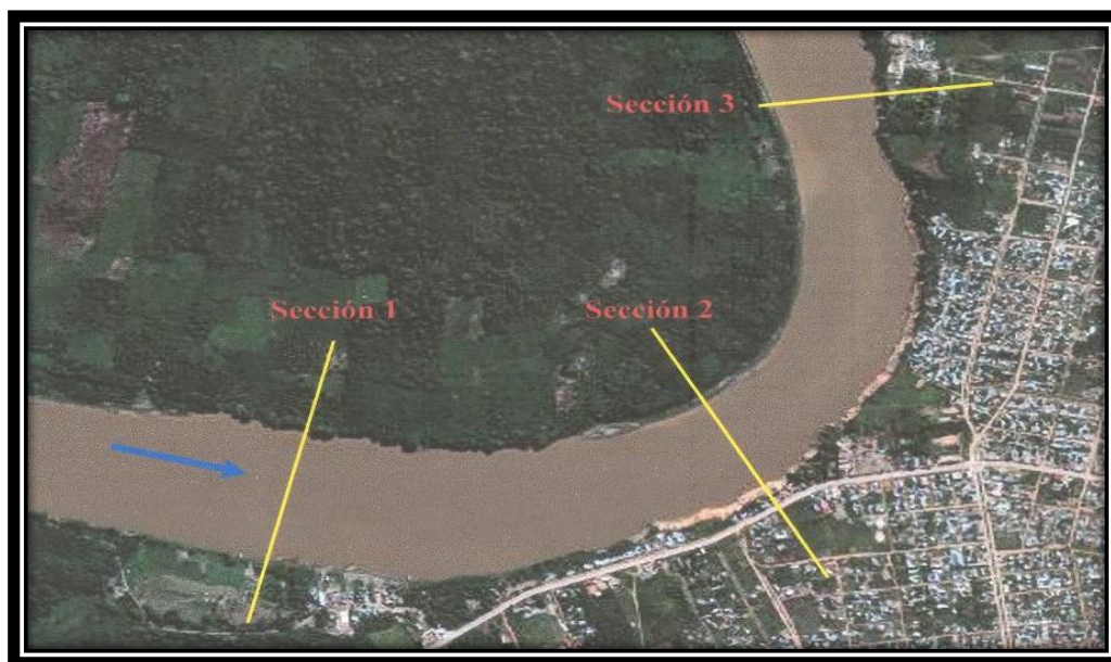
Figura 103: Secciones de lectura de velocidades por el Laboratorio Nacional de Hidráulica. Fuente: Laboratorio Nacional de Hidráulica.
