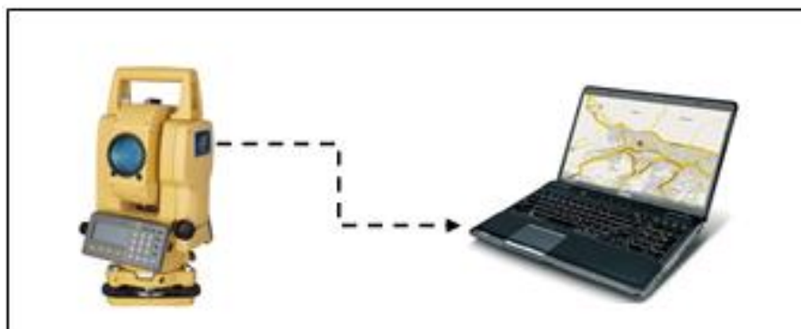
Figura 01. Transferencia de información de Estación Total a Laptop.
