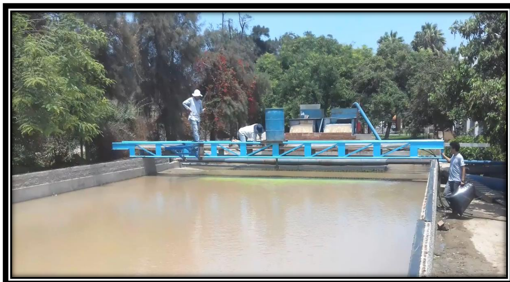
Figura 144: Incorporación de Fluoresceína al flujo. Fuente: Elaboración Propia.
