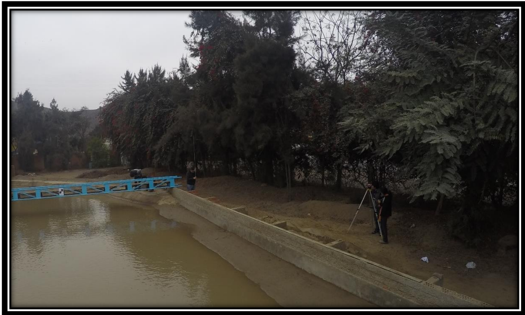
Figura 137: Lectura de BM3 para la obtención de niveles de agua en el modelo físico. Fuente: Elaboración Propia.
