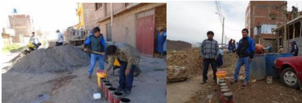
*Figura 40. Elaboración de probetas sin aditivo*
