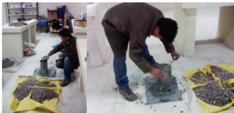
Figura 20. Peso unitario suelto y compacto del agregado grueso
