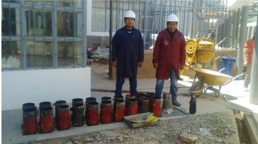
Figura 27. Instrumentos utilizados en la elaboración de probetas de concreto
