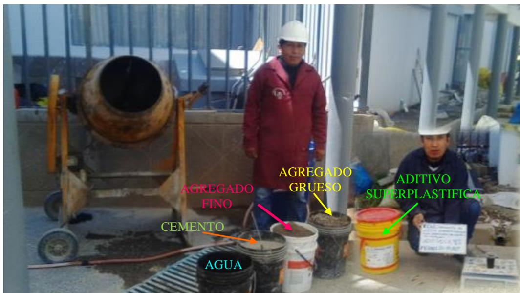
Figura 7: Materiales usados para la fabricación del concreto.
