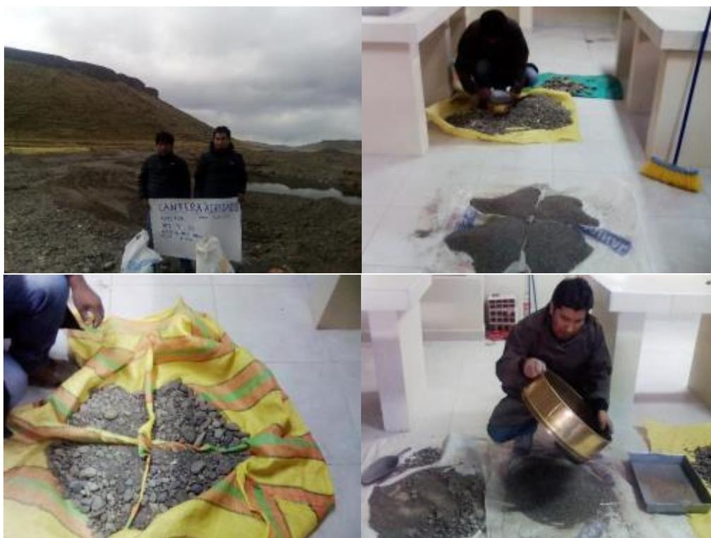
*Figura 21. Análisis Granulométrico – A. Fino y A. Grueso*
