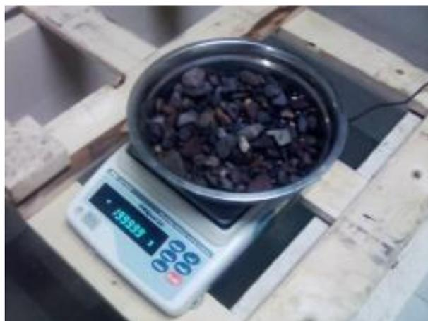
Figura 16. Muestra saturada y superficialmente seca S.S.S
