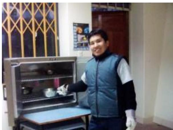
Figura 17. Colocación del material en el horno para su posterior pesaje
