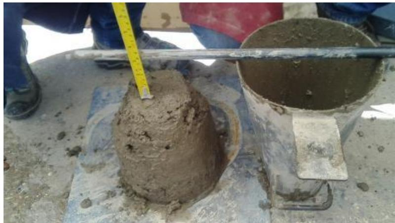
*Figura 31. Ensayo de slump medido en la elaboración de probetas de concreto.*
