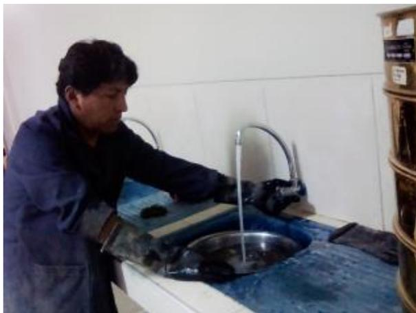
*Figura 14. Lavado y posterior saturado del agregado grueso*
