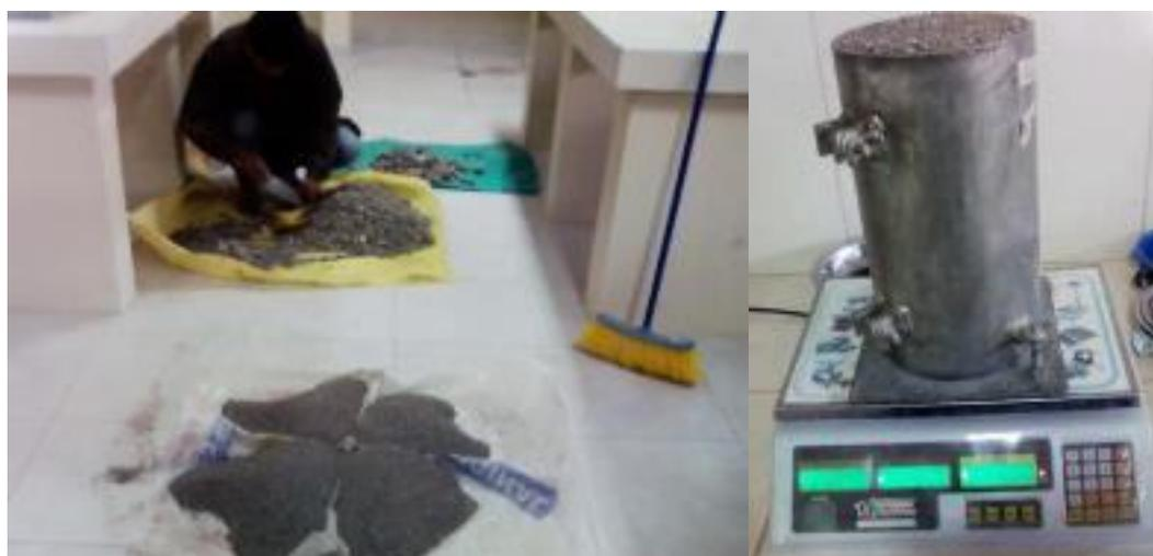
*Figura 19. Peso unitario suelto y compacto del agregado fino*
