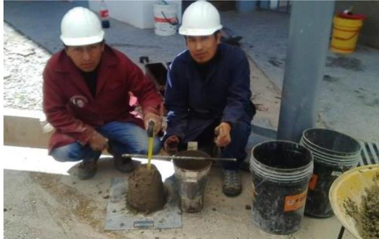
*Figura 30. Ensayo de revenimiento o asentamiento en el cono de Abrams*
