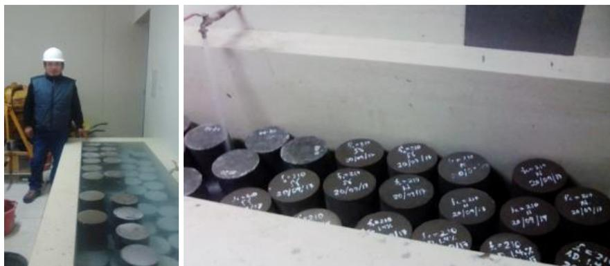
Figura 29. Curado de especímenes de prueba
