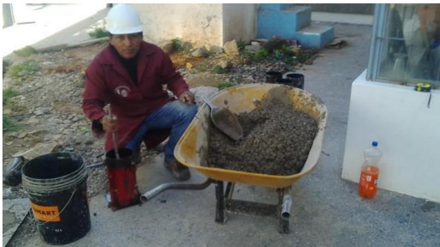
Figura 28. Elaboración de probetas cilíndricas
