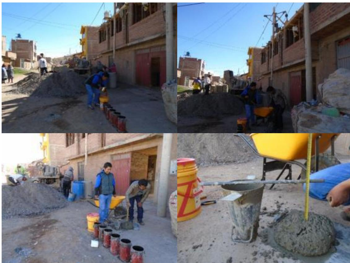
*Figura 39. Asentamiento con aditivo. Se observa un concreto muy fluido. Slump = 8 1/2"*
