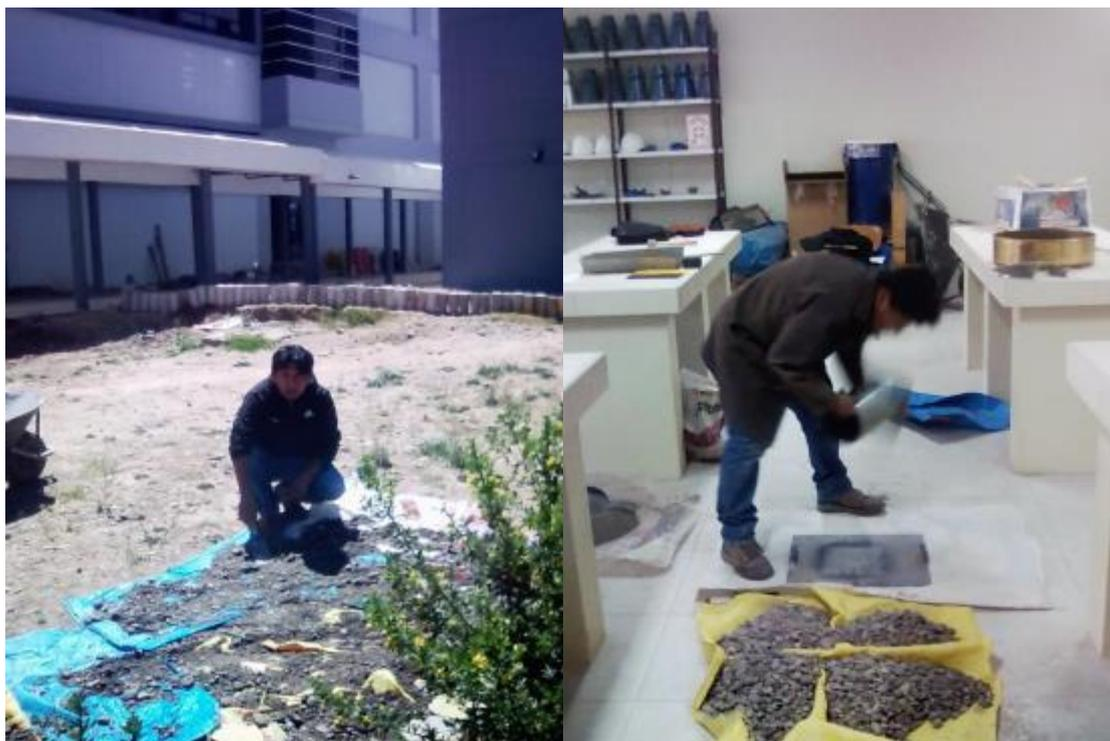
Figura 23. Material de la Cantera de Cutimbo separado por mallas 11/2” y #4.
