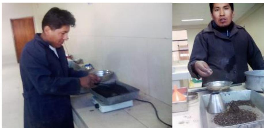
Figura 13. Procesos para la obtención del peso específico de los agregados
