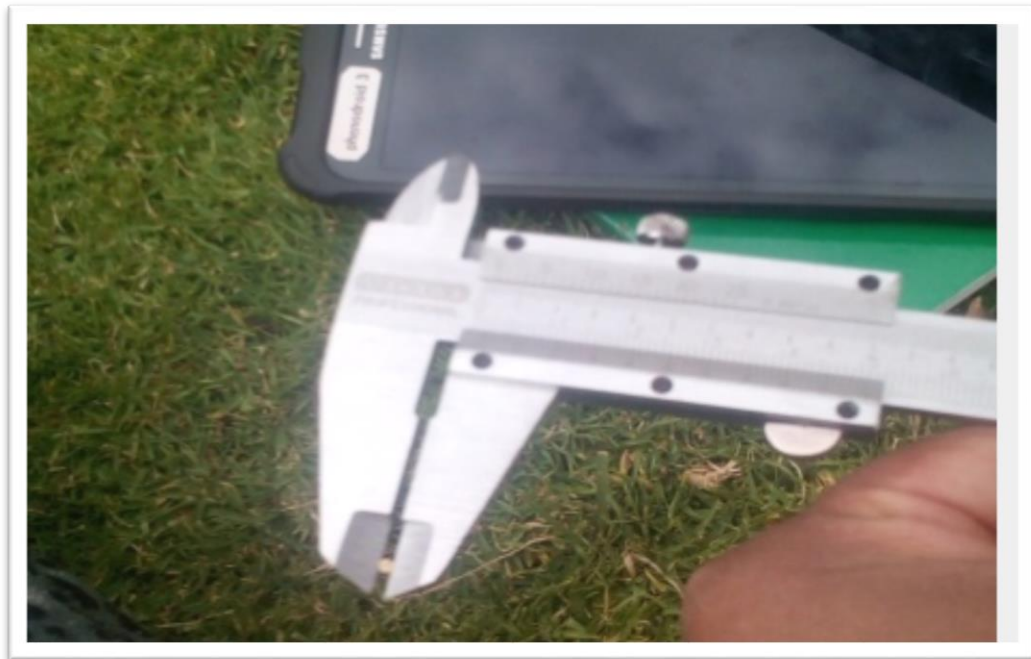
Imagen 19. Midiendo el diámetro de grano con la regla vernier
