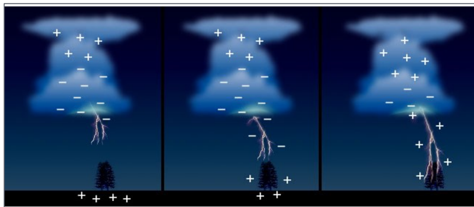
Figura N° 2.4: Formación del Canal del líder positivo y negativo.
