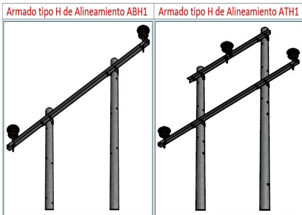
Figura N° 4.3: Estructuras tipo H de alineamiento existentes.
