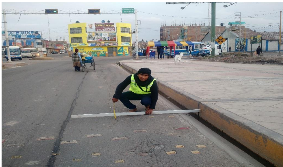
Figura 3. 5. Evaluación del pavimento con una regla de aluminio (Fuente: Elaboración propia)
