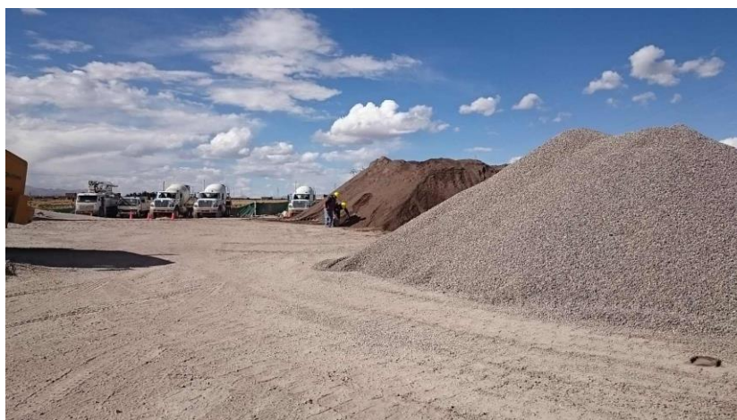
Figura 26 : Acopio de Agregados en planta dosificadora – SuperMix S.A.
