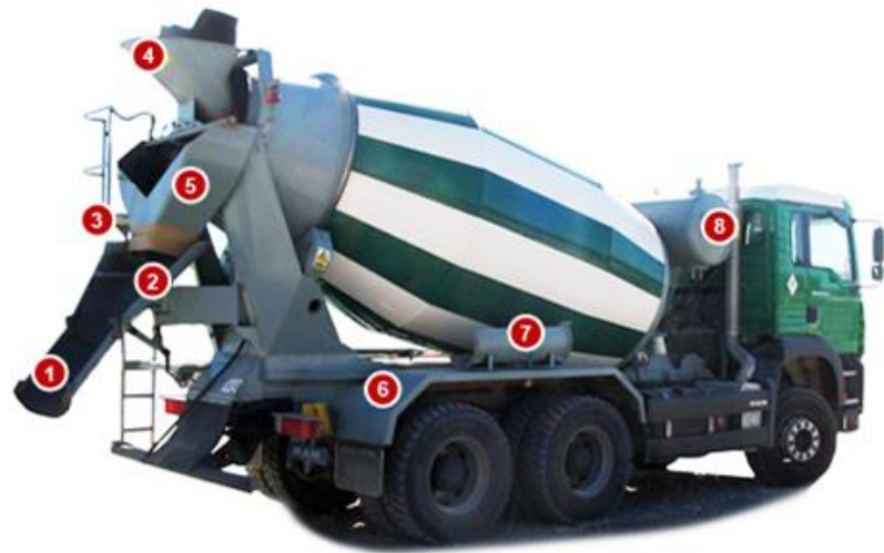
Figura 23 : Componentes típicos de un Camión Mixer.
