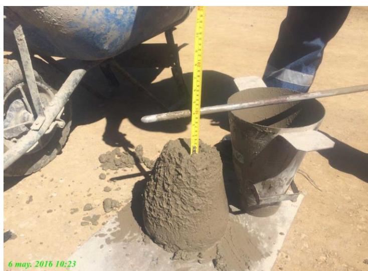
Figura 51 : Técnico de campo realizando ensayo con el cono de Abrams Fuente: Fotografía Propia
