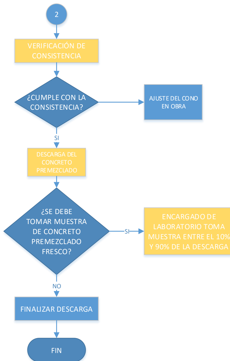
Figura 09 : Diagrama de flujo de fabricación de Concreto Premezclado.
