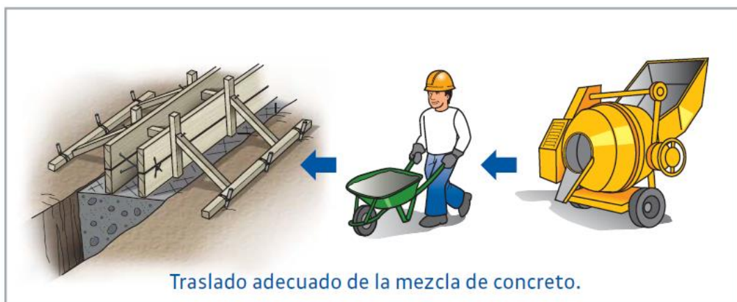
Figura 18 : Transporte de Concreto
