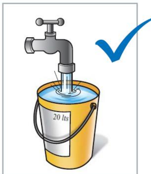
Figura 14 : Usar agua potable para dosificación de concreto.
