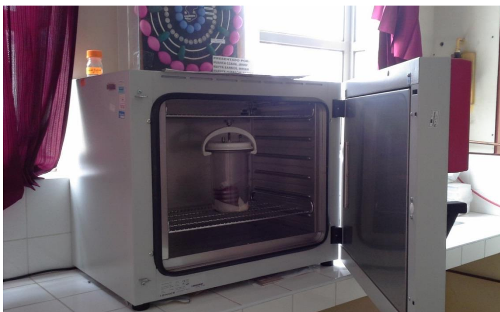
Figura 12. Placas de agar Skirrow en jarra de anaerobiosis, siendo incubadas a 42°C. Laboratorio de Microbiología FCCBB UNA-PUNO (octubre 2016 – enero 2017).
