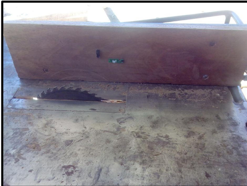
Instalado de los sensores a la guía de la máquina.
