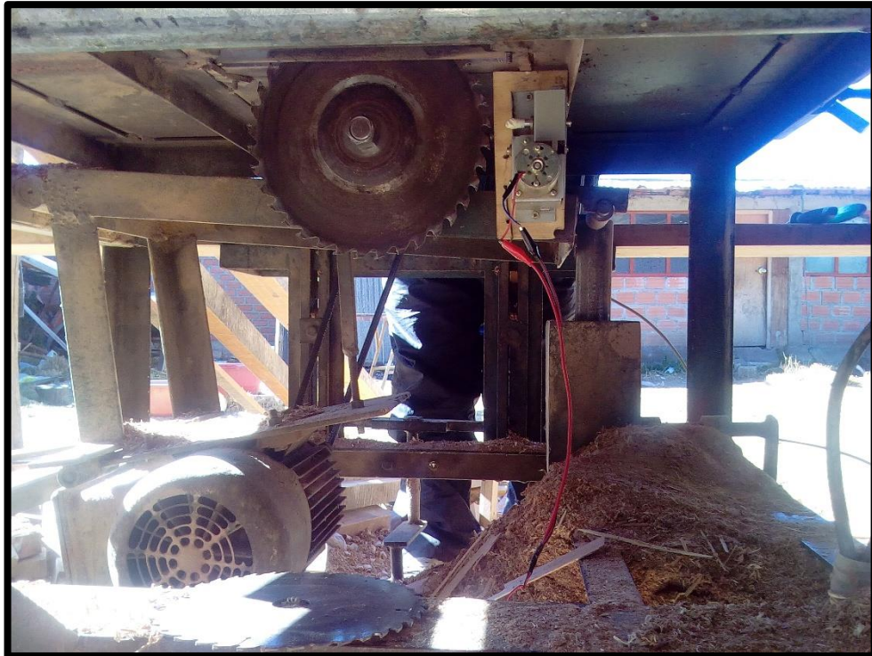
Instalado del freno a la cierra disco.
