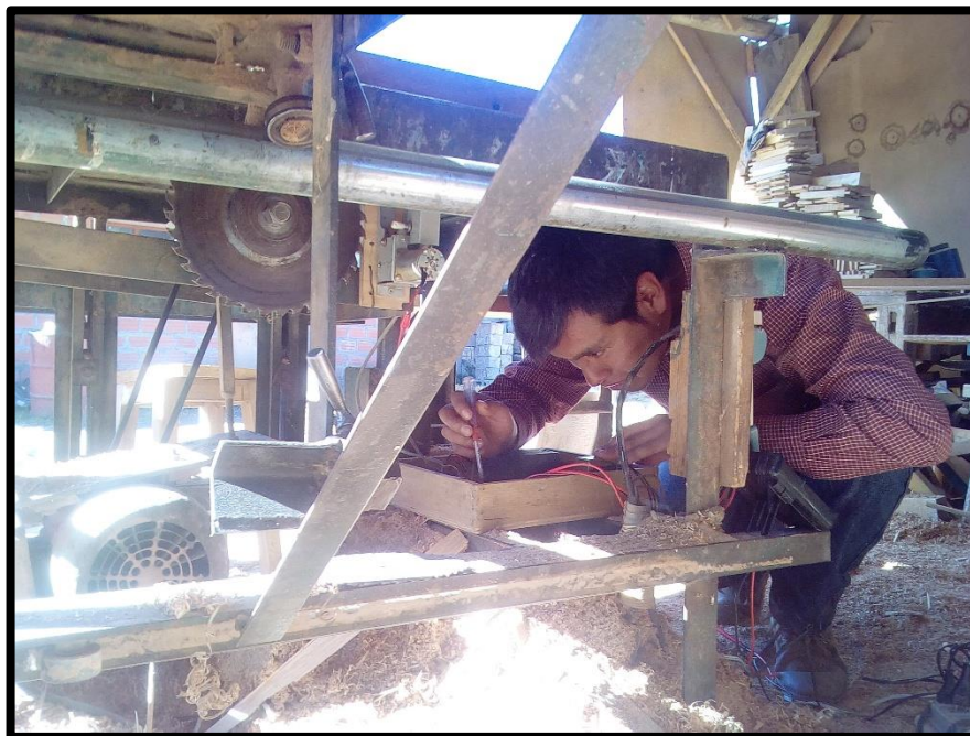
Comprobado de voltajes en las salidas y entradas del sistema de seguridad.
