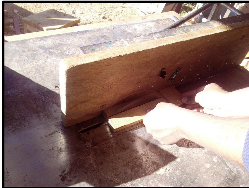
Aplicado del sistema de seguridad durante el cortado de madera.
