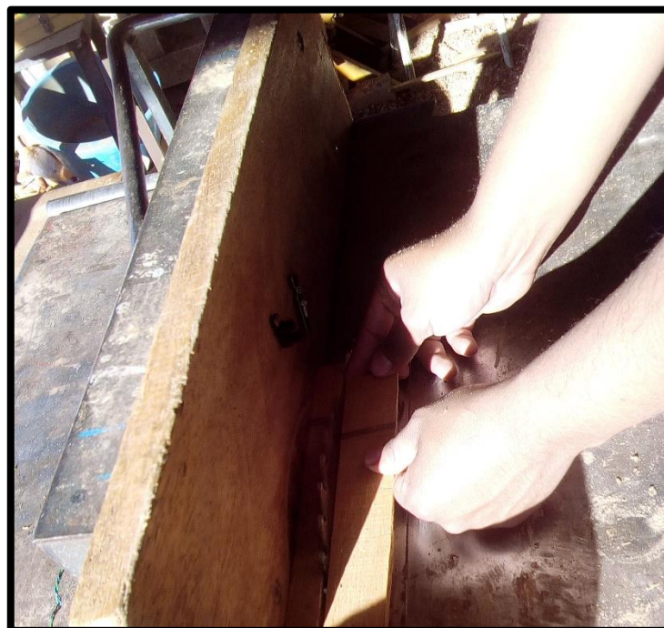
La máquina se detuvo al detectar las manos del personal cerca cierra disco.
