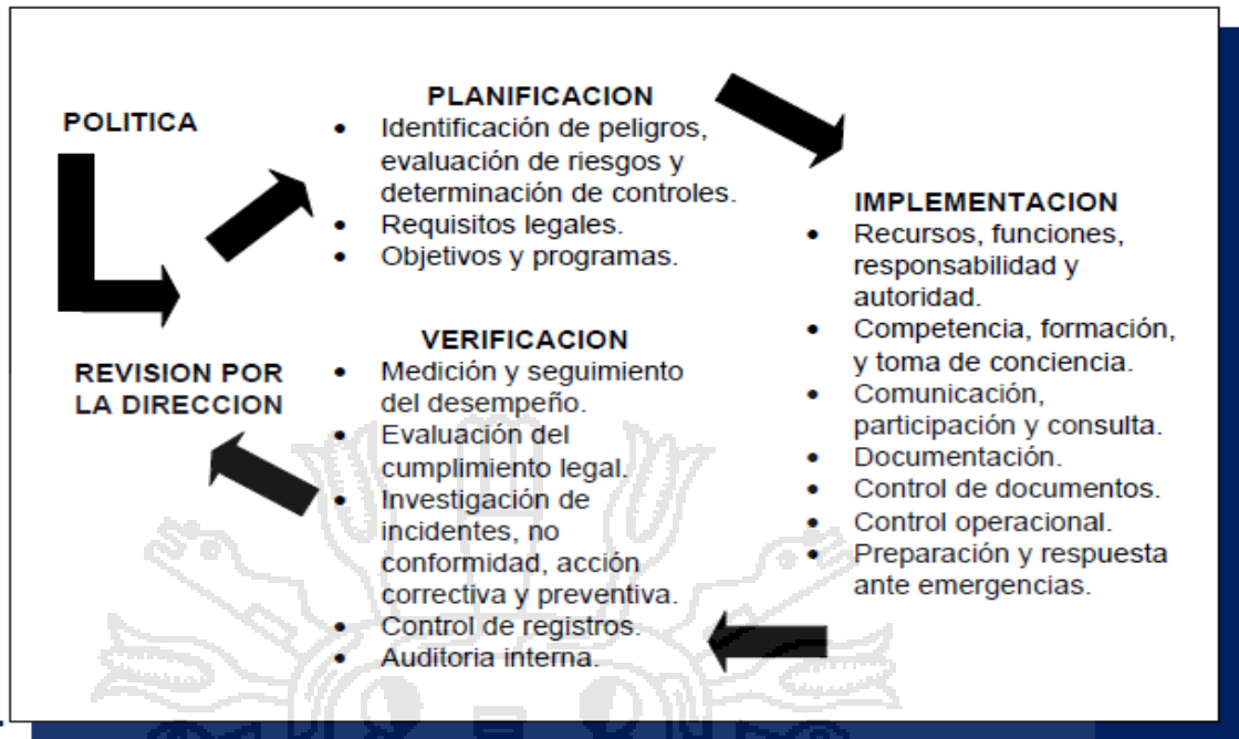
Figura 11. Elementos del sistema de gestión de seguridad y salud en el trabajo (SGSST).
