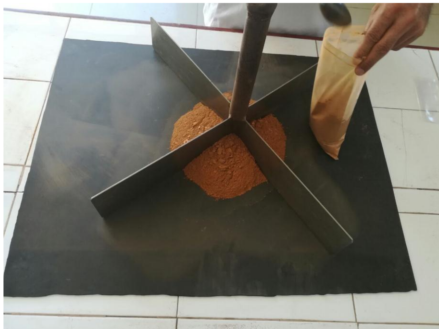
Figura 8. Cuarteo de muestra - Laboratorio Metalúrgico.
