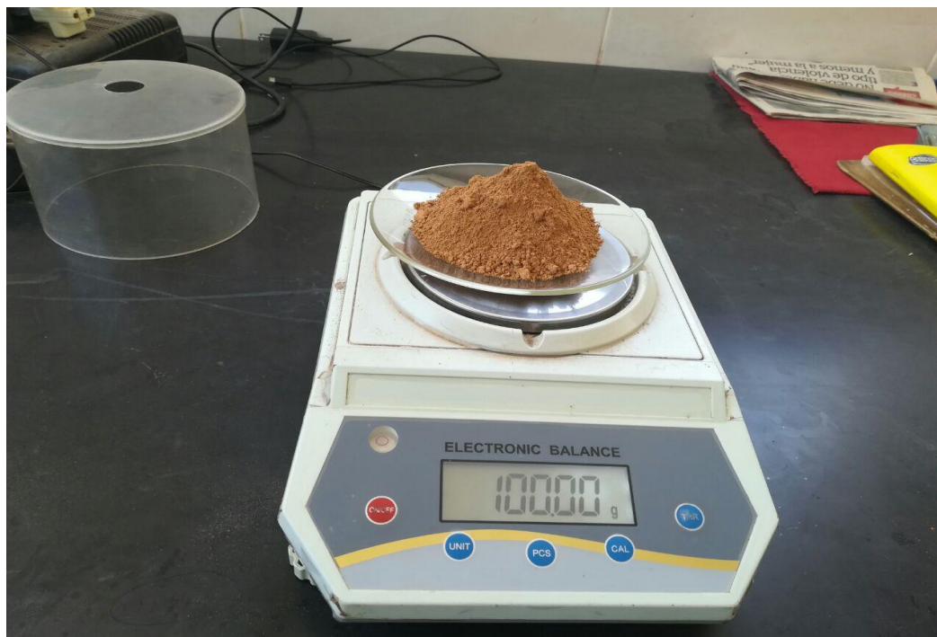
Figura 9. Pesado de muestra - Laboratorio Metalúrgico.
