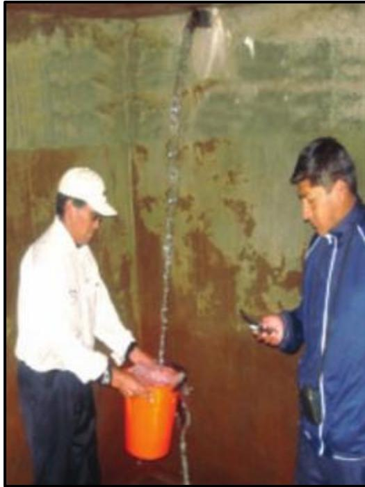
Medición del caudal del agua a la entrada del tanque de almacenamiento.
