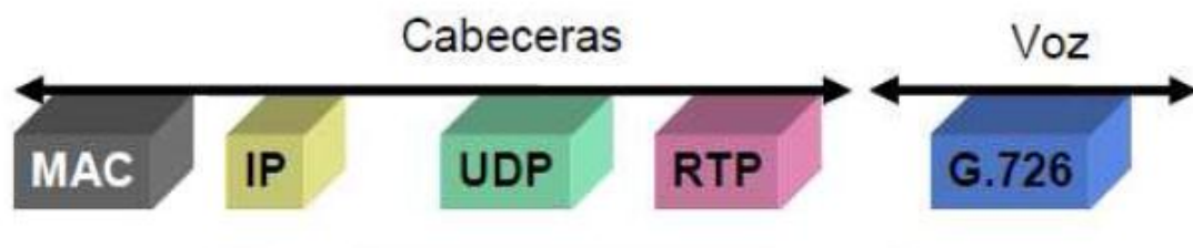
Figura N° 4. 4: Gráfica de cabeceras y voz para el códec g.726.
