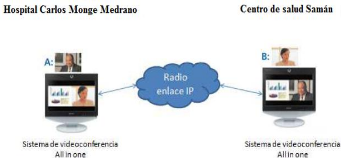
Figura N° 3. 6: Diagrama de red videoconferencia IP.
