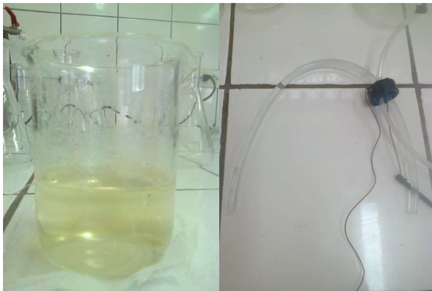
Figura 29. Preparación del puente salino y acondicionamiento al tubo en U
