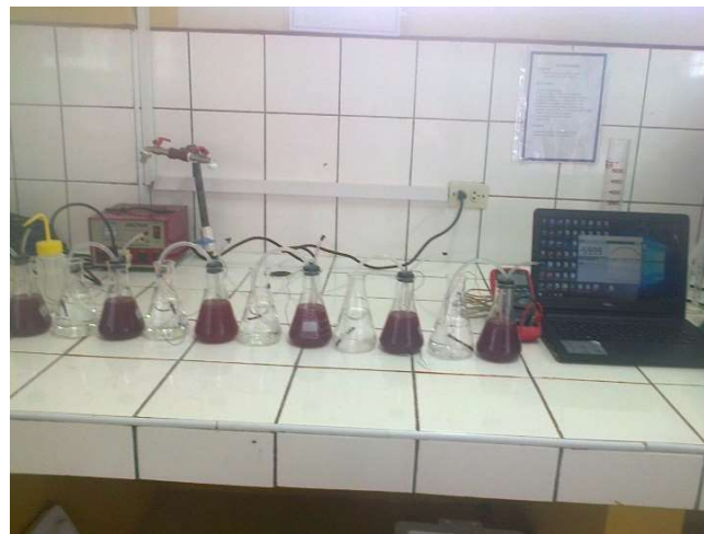
Figura 31. Funcionamiento de las CCM durante el proceso de experimentación.
