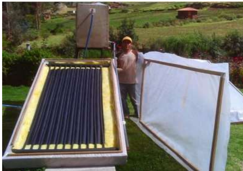
Figura 15. Presentación de la terma solar con su tanque de abastecimiento de agua
