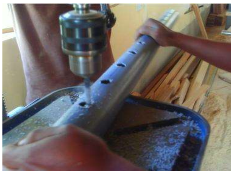
Figura 6. Construcción de orificios para el empalme de tubos
