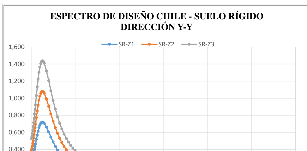
Gráfico 8: Espectro de diseño en Chile, dirección Y-Y, suelo rígido.
