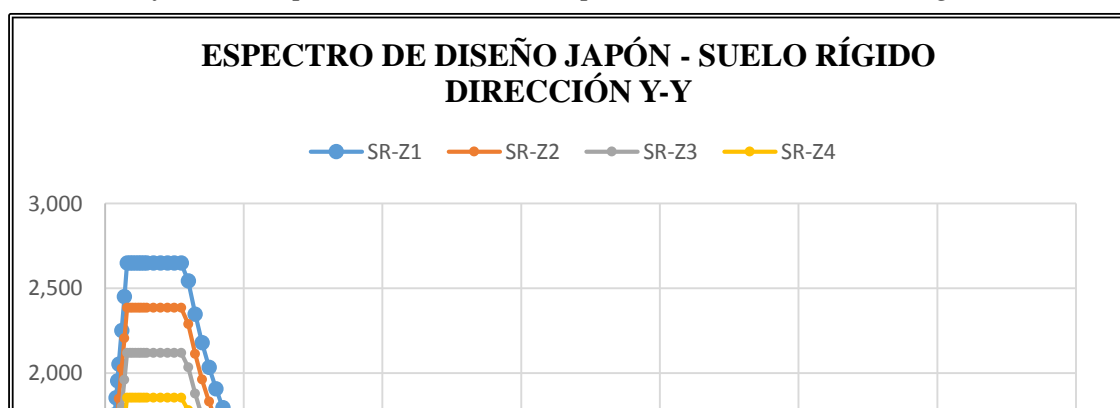
Gráfico 20: Espectro de diseño en Japón, dirección Y-Y, suelo rígido.
