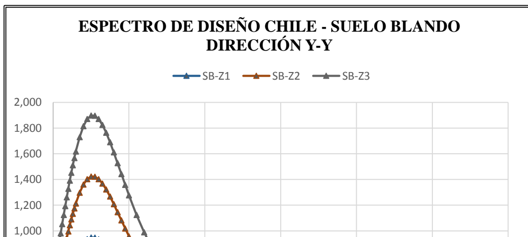
Gráfico 12: Espectro de diseño en Chile, dirección Y-Y, suelo blando.
