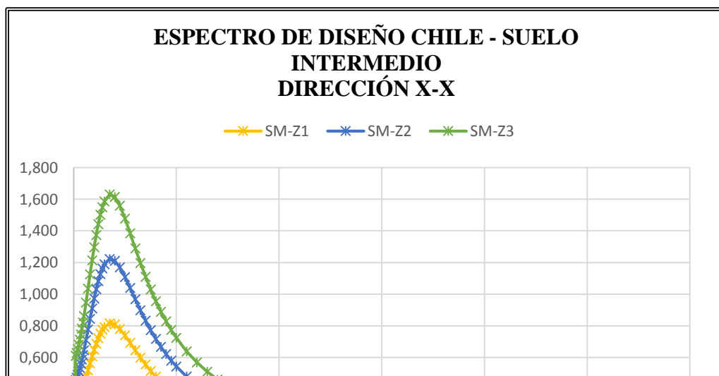
Gráfico 9: Espectro de diseño en Chile, dirección X-X, suelo intermedio.
