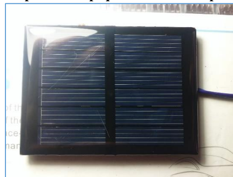
Figura 3.7: panel solar pequeño usado como piranometro.
