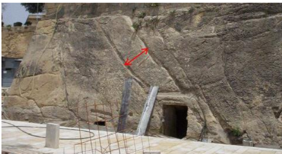
Figura 2. 3 El espaciado de las juntas en una falla de tipo normal
