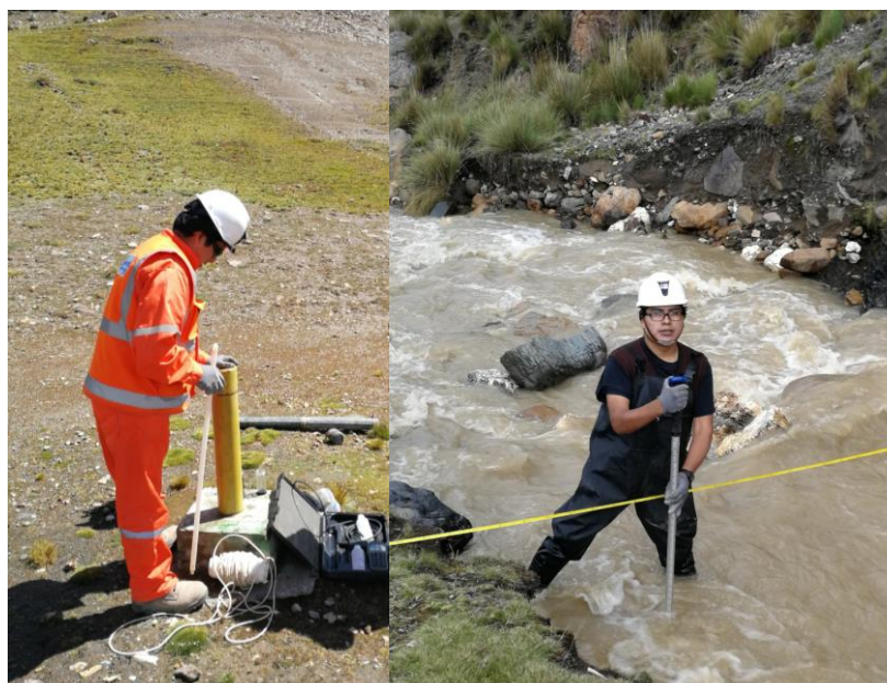
Foto 2 y 3; Monitoreo de niveles piezométricos Pz-08 y Aforo caudal quebrada Chumpe.
