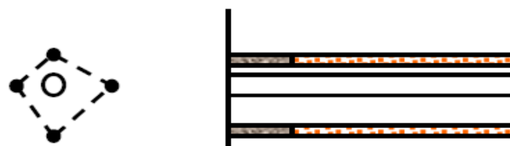
Figura 2.11 Irregular longitud de los taladros Fuente: Exsa 2 001, Manual práctico de voladura
