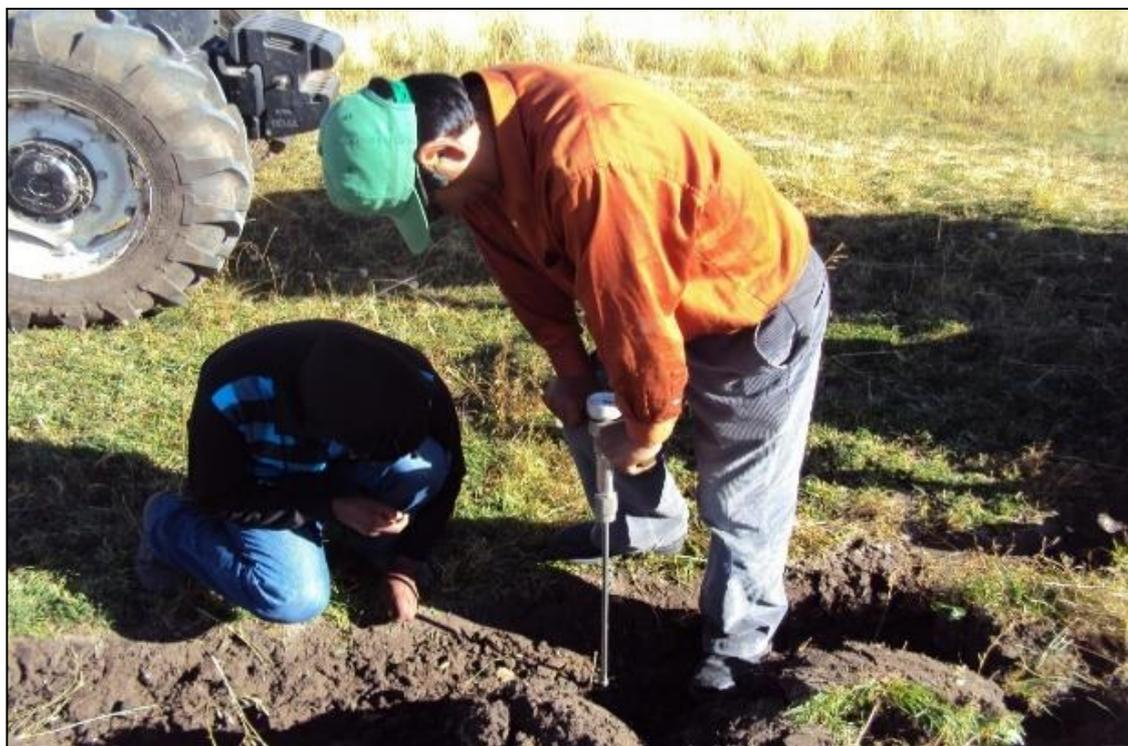
**Figura 1.** Penetrómetro lecturando de manera directa la resistencia a la penetración.
