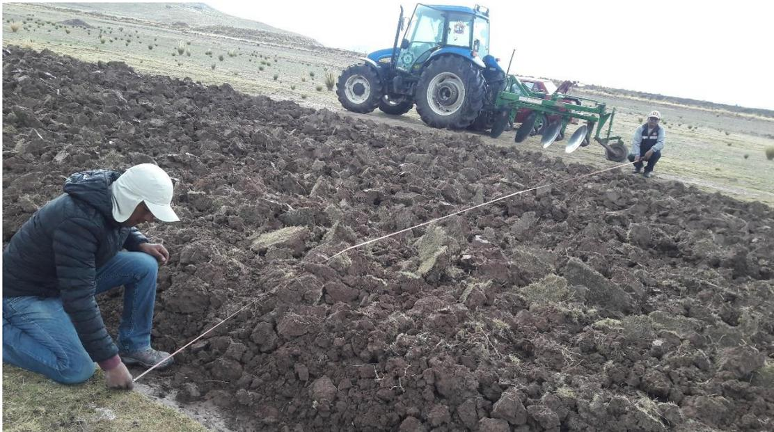
**Figura 21.** Medición de área de trabajo realizado por el tractor de 98 HP con arado.
