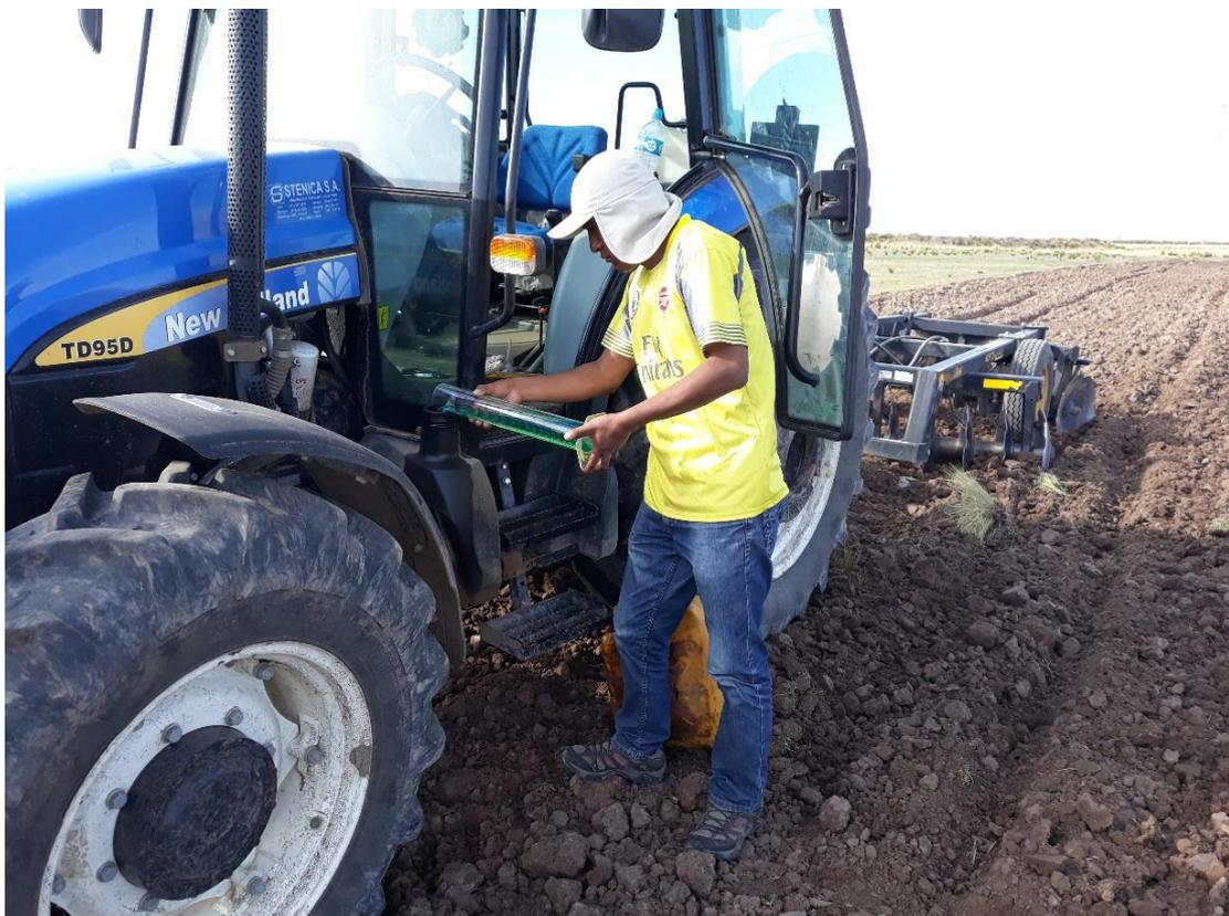
**Figura 18.** Medida del combustible consumido al tractor de 98 HP con rastra.
