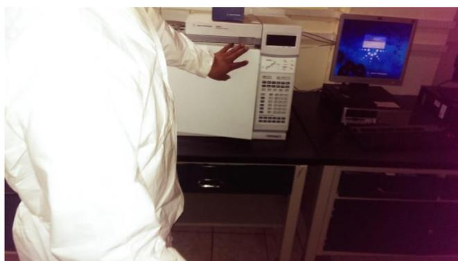
12. Análisis con cromatografo de gases de aceite esencial
