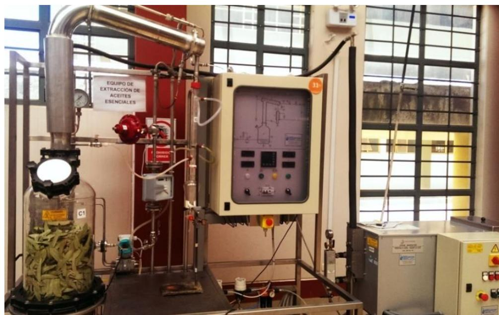
**Figura 13.** Equipo modular de extracción de aceites esenciales de la FIQ UNA Puno.
