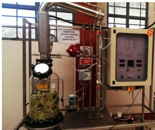
10. Proceso de extracción de aceite esencial de eucalipto
