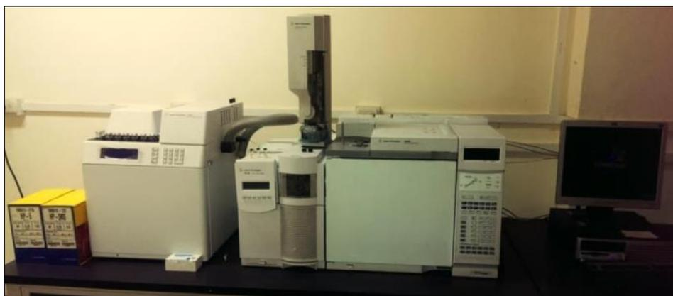
**Figura 14.** Cromatografo de gases acoplado a espectrómetro de masa. UNSAAC
