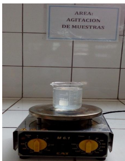
D1. Agua residual tratada con floculantes.
