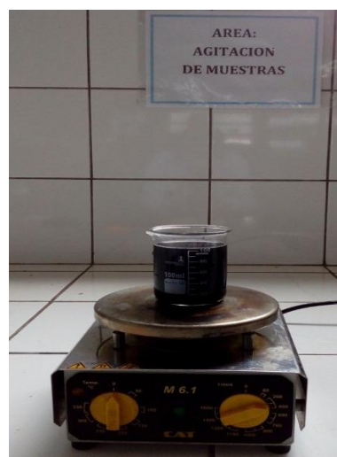
D2. Adsorción de detergentes con CACP y CACC
