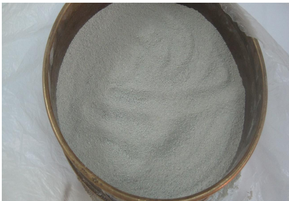
Figura 12: Tamizado del “chacco” en malla N° 50
