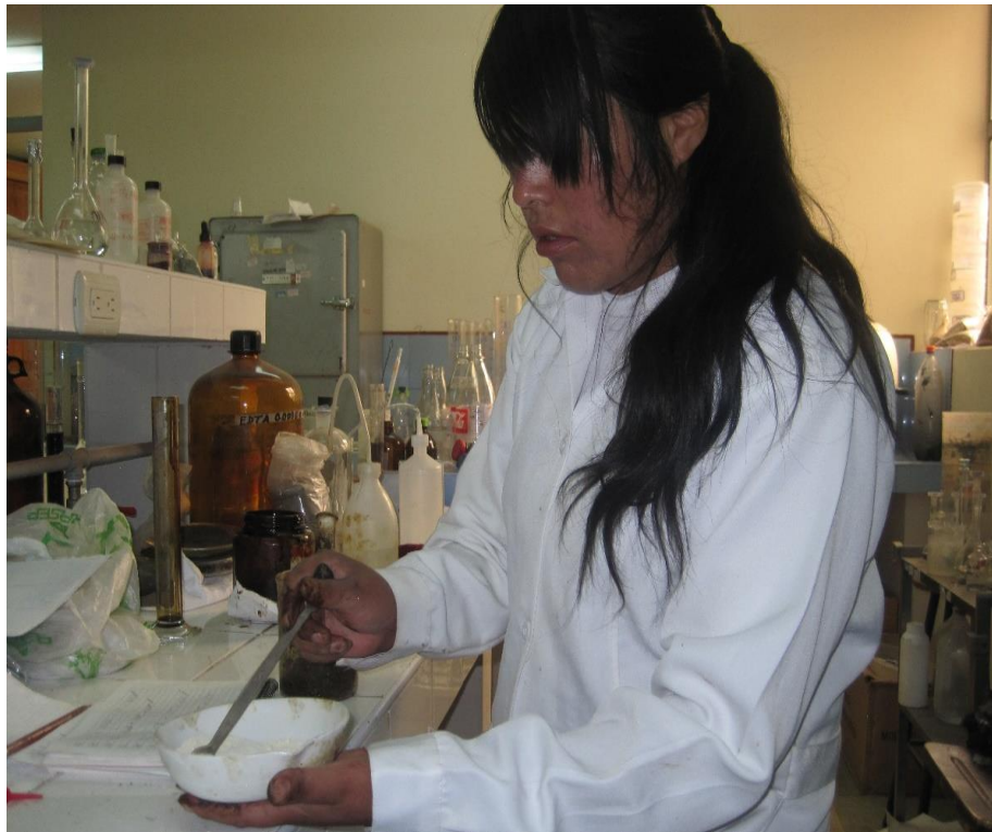
Figura 15: Preparación del material peletizante: Harina de tarwi, chacco, jamallachi
