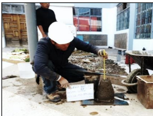
Figura 3.10. Ensayo de asentamiento cono de Abrams.
