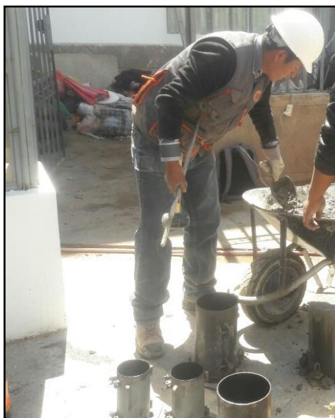
Figura 3.7. Llenado de moldes y apisonado de mezcla de concreto en tres capas iguales.
