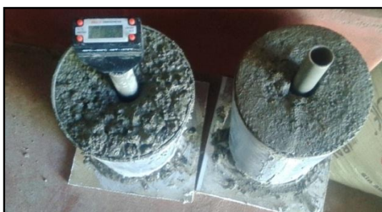
Figura 3.11. Realización del ensayo de temperatura del concreto.
