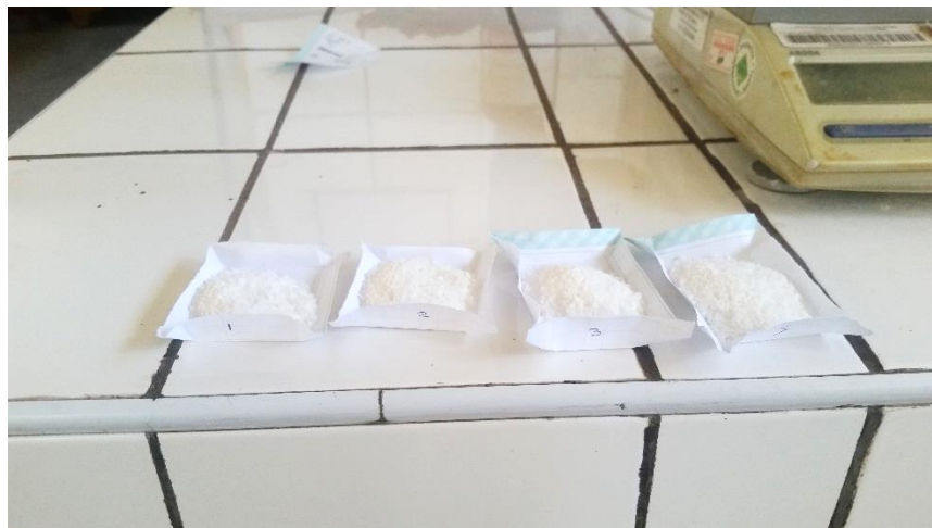
Foto 2: Pesando el coagulante Al_2(SO_4)_3 y el floculante Ca(OH)_2
