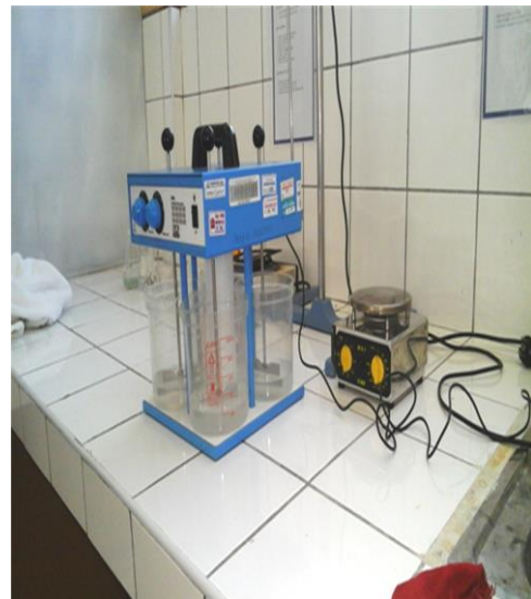
Foto 4: Equipo de Prueba de jarras (Jar – Test)
