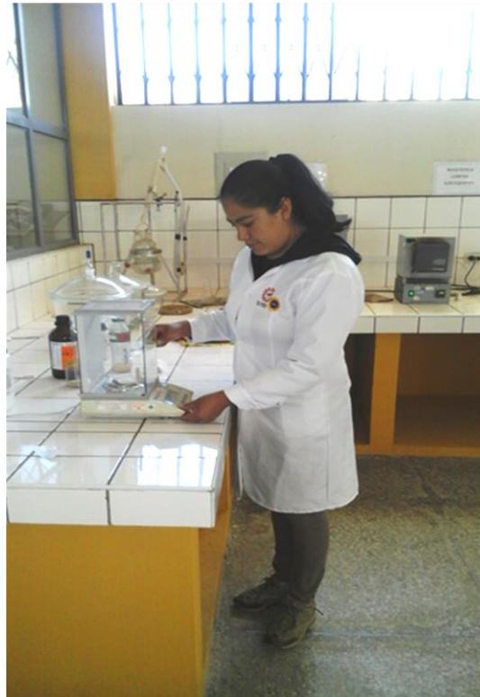
Foto 1: Pesado del coagulante y floculante
