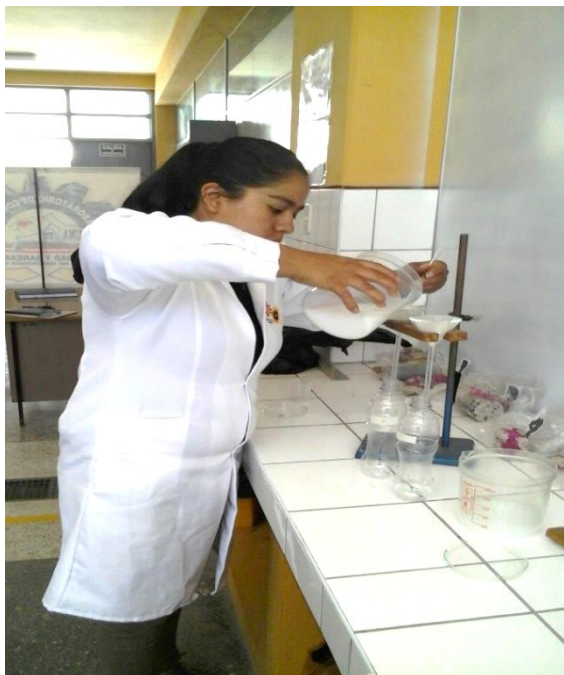
Foto 6: Filtrando el contenido de aguas con arsénico luego de la coagulación - floculación
