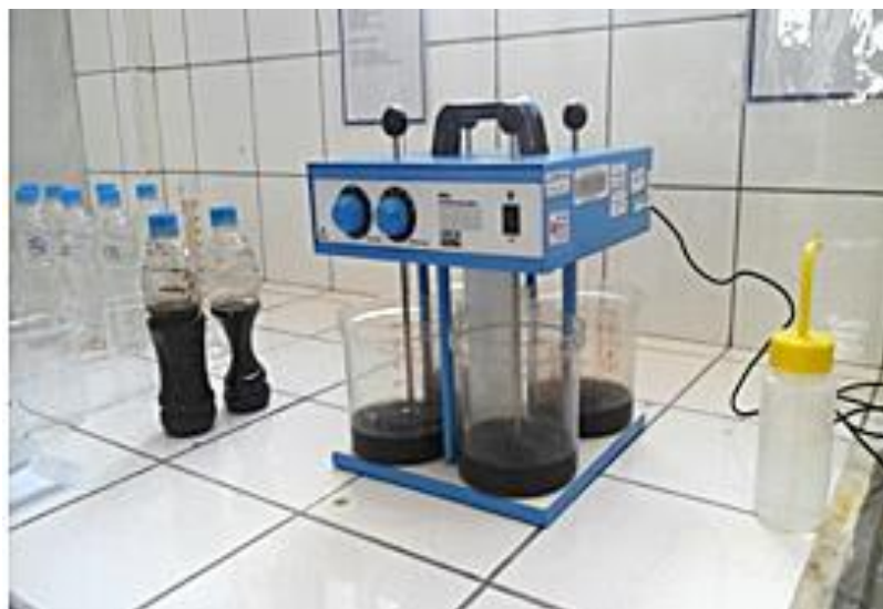
Figura 4: Instalación experimental para el ensayo de coagulante
