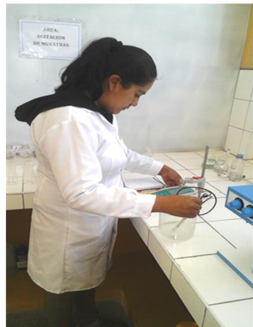
Foto 6: Filtrando el contenido de aguas con arsénico luego de la coagulación - floculación
