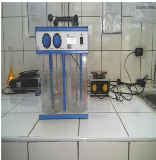
Foto 4: Equipo de Prueba de jarras (Jar – Test)
