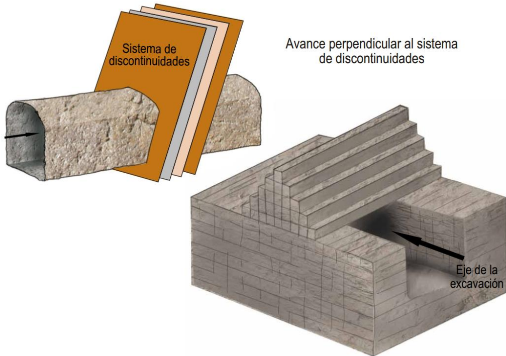
Figura 8: Condiciones de avance muy favorables para la estabilidad.
