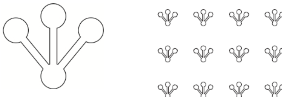
Figura 19. Micro PAD diseñado escala 1:1
