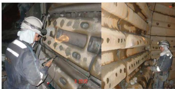
Figura N ° 12 Control de desgaste revestimientos mediante ultrasonido. Fuente: Rajamani, 2001. Clearcy, 2001. Magne 2003
