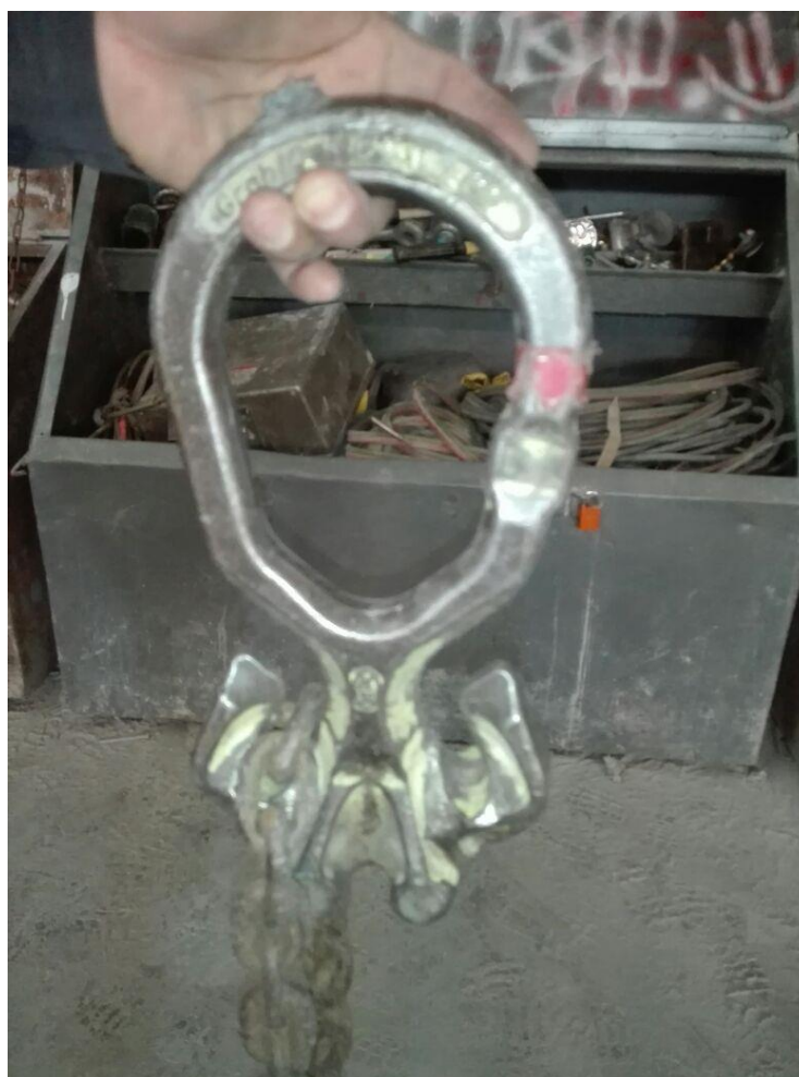
Figura N° 22. Gancho de izaje de forros Fuente: Elaboración propia
