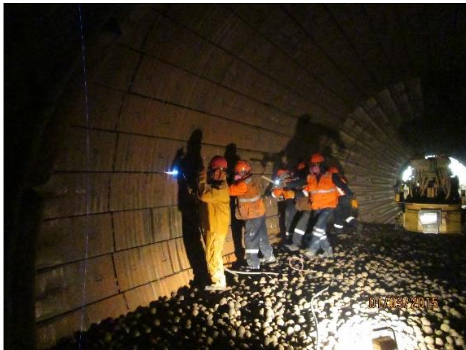
Figura N° 18. Corte de Planchas desgastadas molino Fuller Fuente: Elaboración propia
