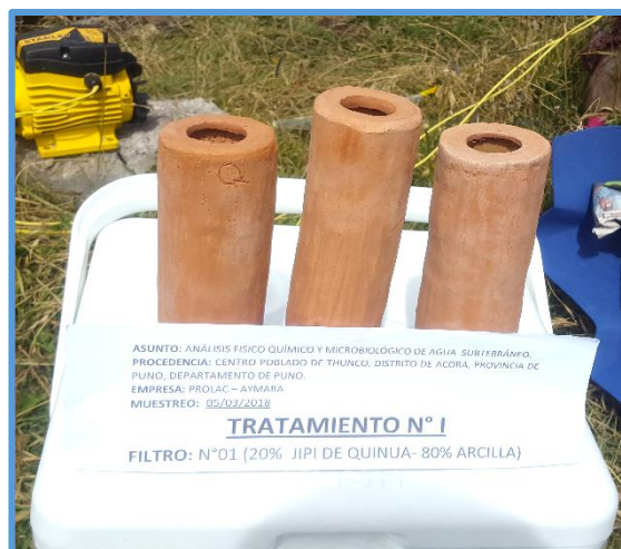
Figura 40: Filtros de tratamiento I
