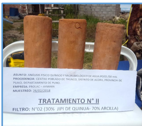
Figura 41: Filtros de tratamiento II
