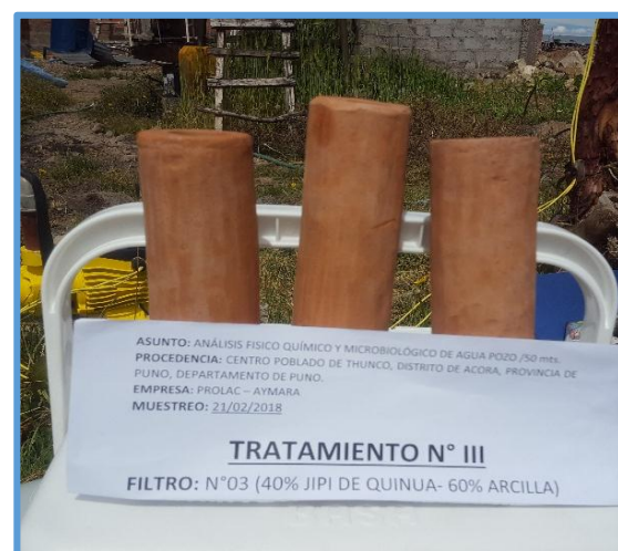
Figura 42: Filtros de tratamiento III
