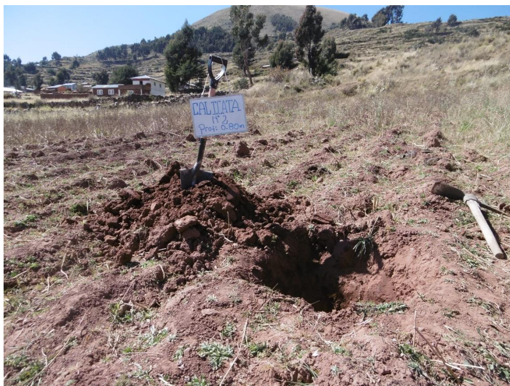
Fotografía N°3: En la imagen se observa la calicata N° 2, para determinar la textura de suelo.
