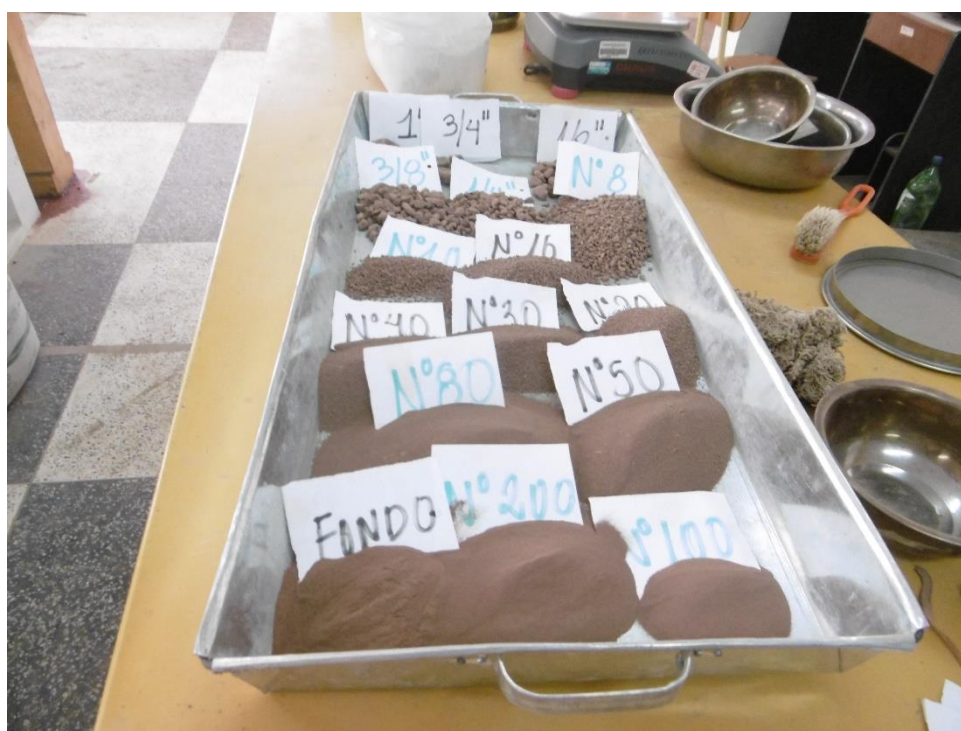
Fotografía N°5: En la imagen se observa el análisis granulométrico ya retenidos en cada malla.
