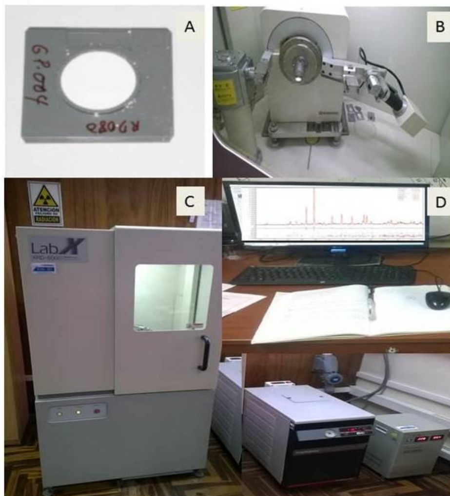
Figura 8: Equipos y materiales para el análisis de Fluorescencia de Rayos X; A) Portamuestras para polvo en difracción de rayos X, con polvo cristalino; B) Portamuestras montado sobre un goniómetro giratorio y un detector; C) Equipo XRD-6000; D) Difractograma presentado en un computador.
