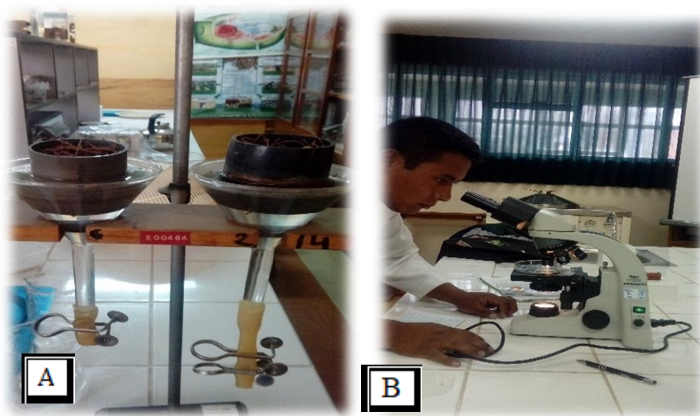
Figura 3 A: Método de Baermann, Embudos conteniendo muestras de suelo y de raíz. B: Identificación en el microscopio. Fuente: Elaboración propia (2016)
