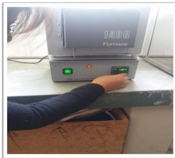
Mufla encendida para produccion de carbon por calcinacion para su posterior activacion.
