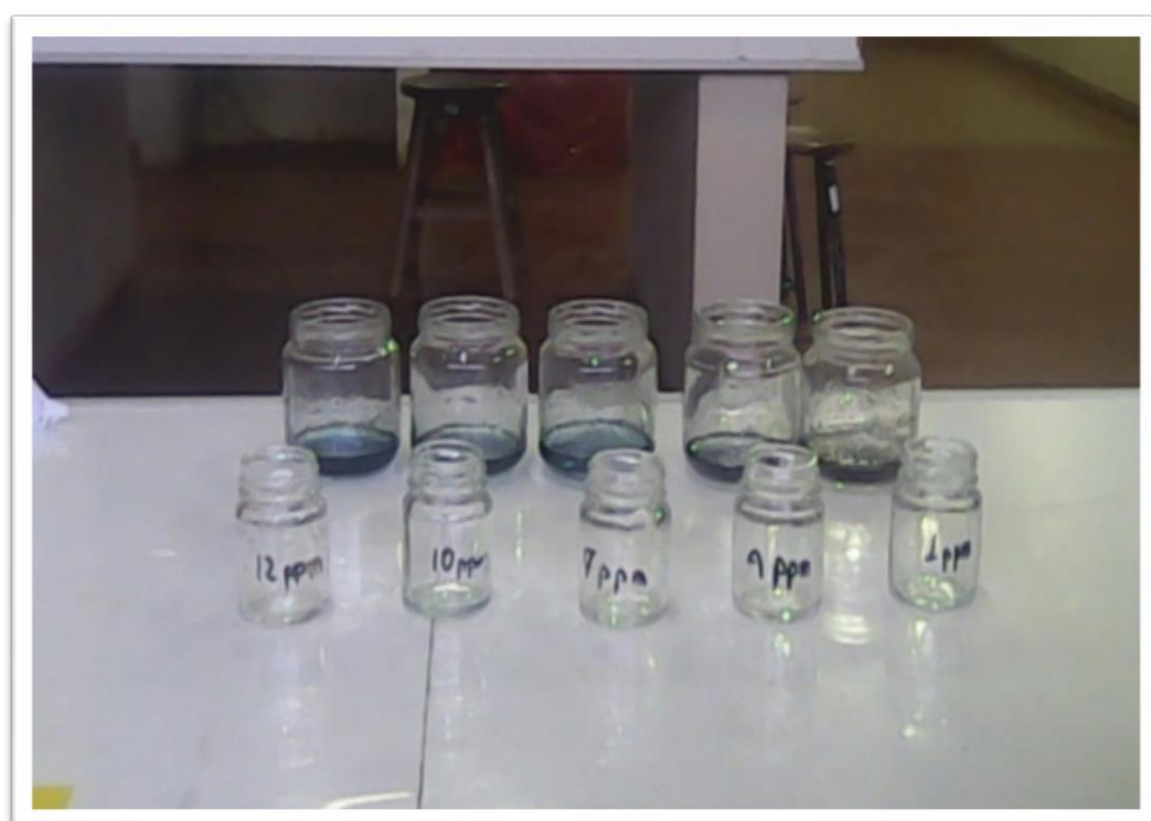
Se agrega el carbon activado de la en el espectrofotómetro UV-Visible tusa de maiz a cada frasco de azul de metileno de la curva patron y se deja en contacto por el tiempo.
