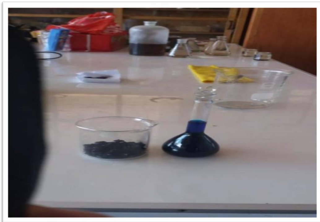
Preparación de la solución del azul de metileno por el carbon activado de patrón de 100ppm y la muestra de la tusa de maiz y luego se lee las absorbancias carbon activado en el espectrofotometro para evidenciar la adsorción
