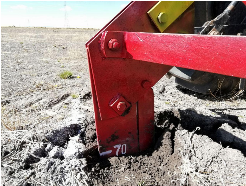
Figura 16. Subsulado a una profundidad de 70 cm en un suelo franco arcilloso
