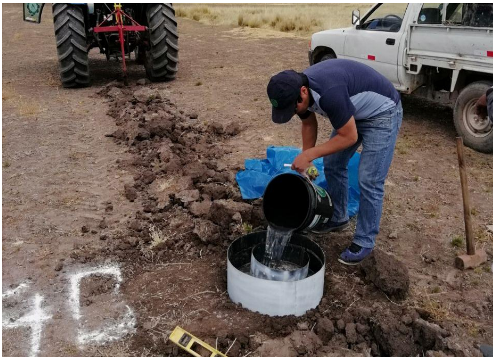
Figura 13. Determinación de la velocidad de infiltración en suelo franco arcilloso a 40 cm de profundidad
