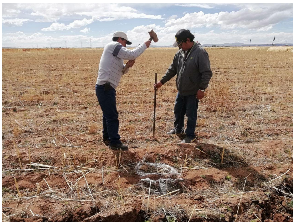
Figura 23. Recolección de muestras para determinar D_a , micro y macroporosidad de una suelo franco arenoso a una profundidad de 40 cm
