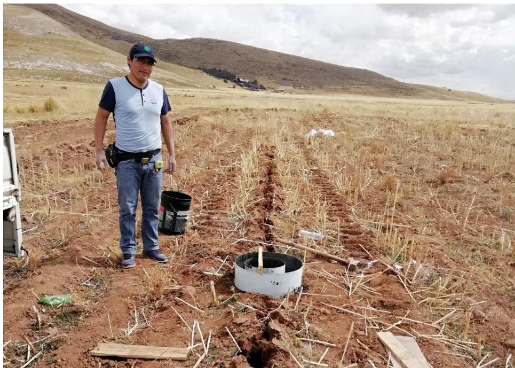
Figura 22. Determinación de la velocidad de infiltración en suelo franco arcilloso a 40 cm de profundidad
