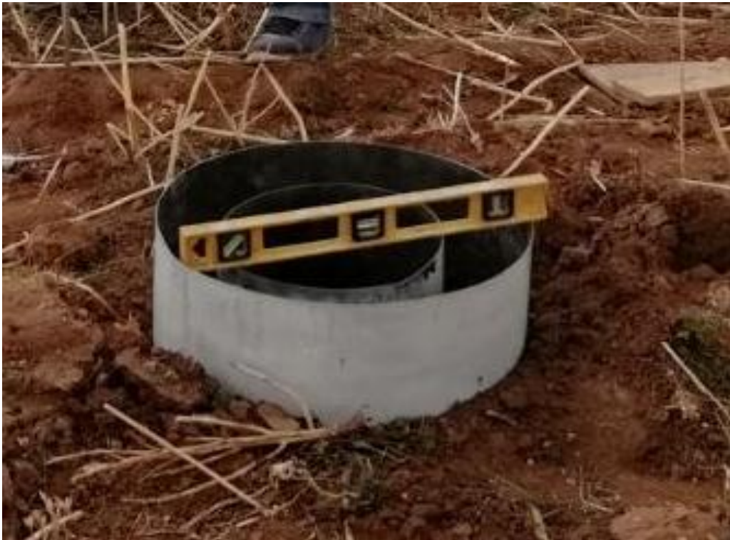
Figura 20. Determinación de la velocidad de infiltración en suelo franco arenoso a 00 cm de profundidad
