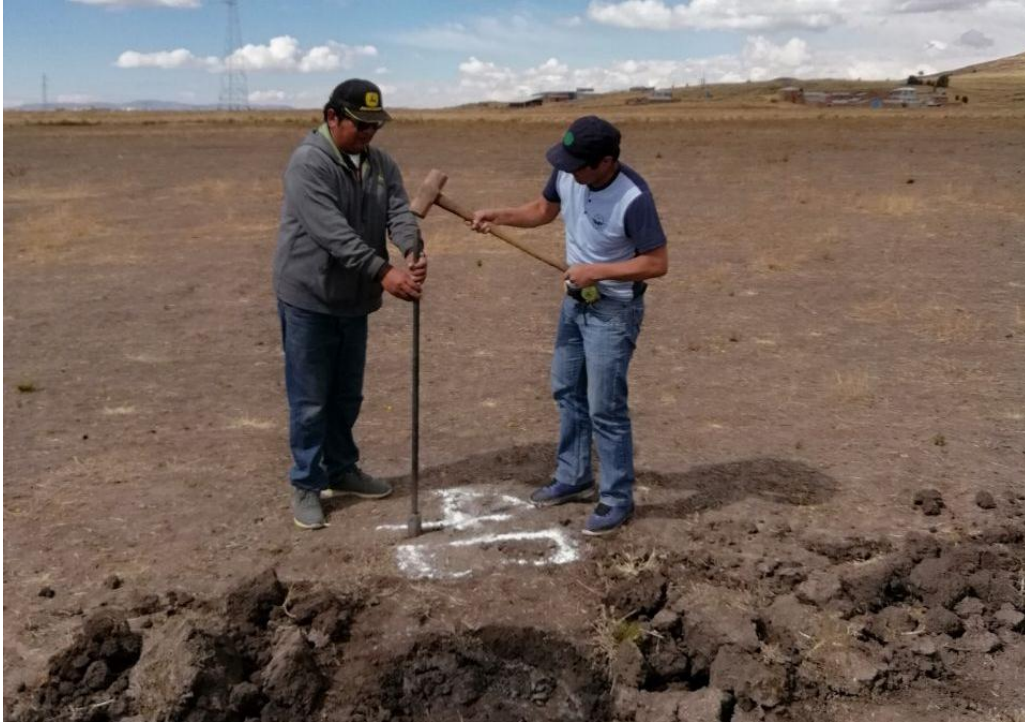
Figura 14. Recolección de muestras para determinar D_a , micro y macroporosidad de una suelo franco arcilloso a una profundidad de 40 cm
