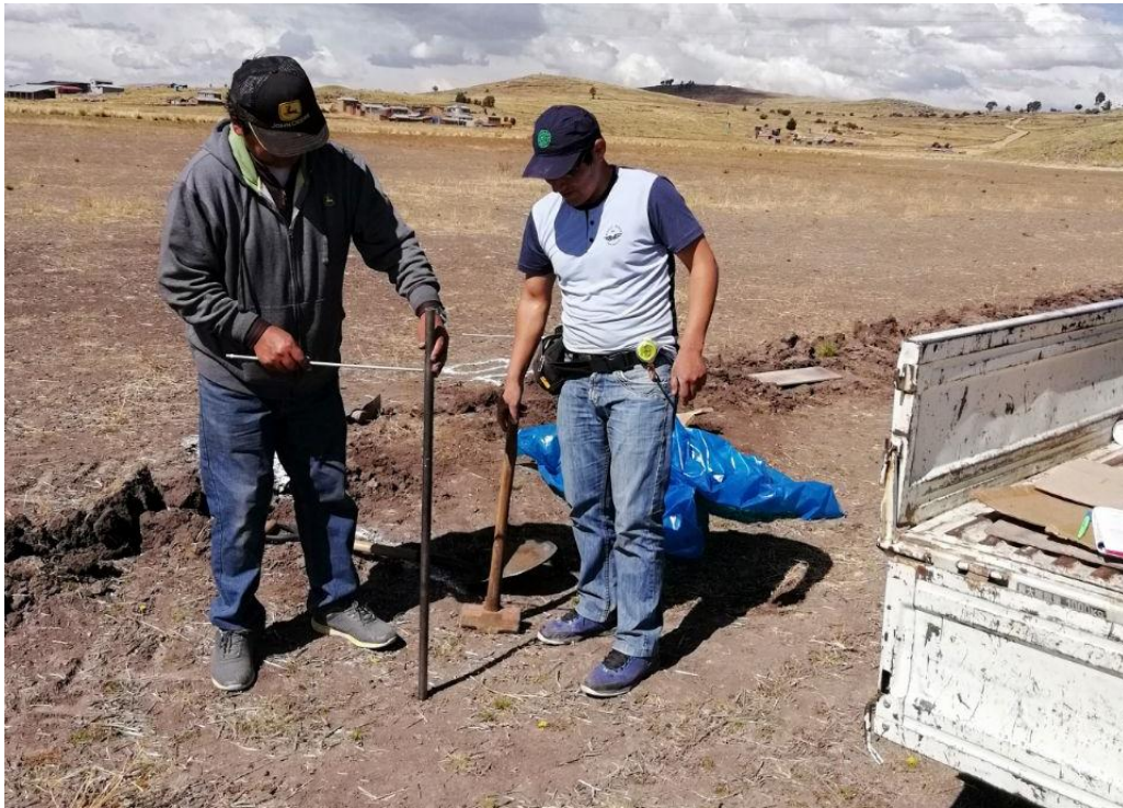
Figura 18. Recolección de muestras para determinar D_a , micro y macroporosidad de una suelo franco arcilloso a una profundidad de 70 cm
