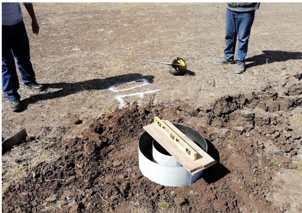
Figura 17. Determinación de la velocidad de infiltración en suelo franco arcilloso a 70 cm de profundidad
