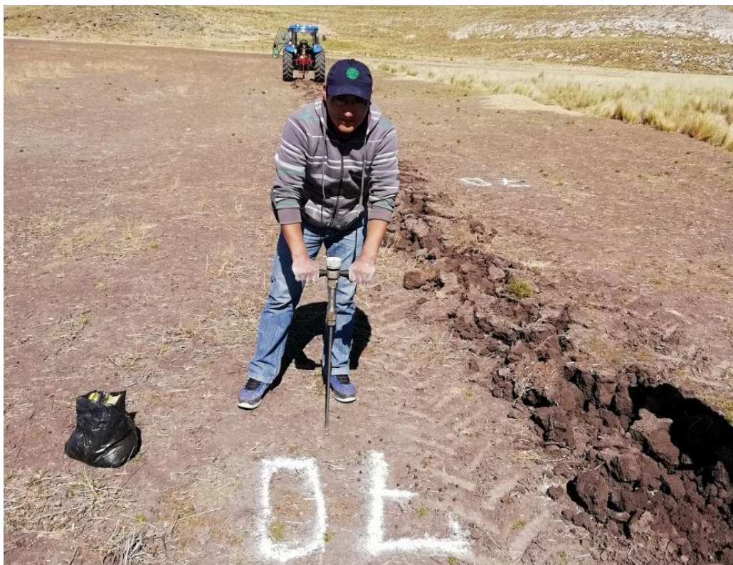
Figura 19. Determinación compactación de suelo a 70 cm en suelo franco arcilloso
