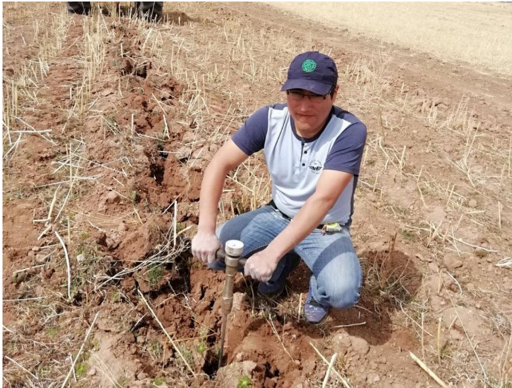
Figura 24. Determinación compactación de suelo a 40 cm en suelo franco arenoso
