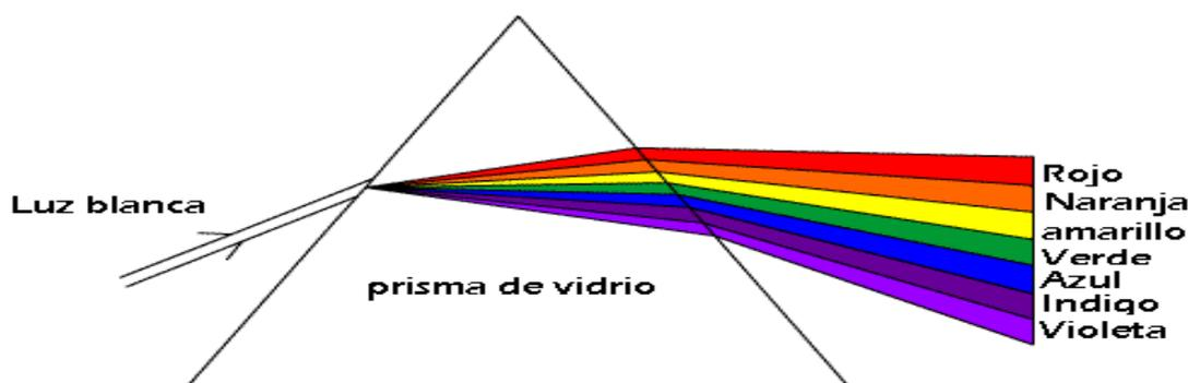
FIGURA 14. INCIDENCIA DE LA LUZ BLANCA SOBRE UN CRISTAL
