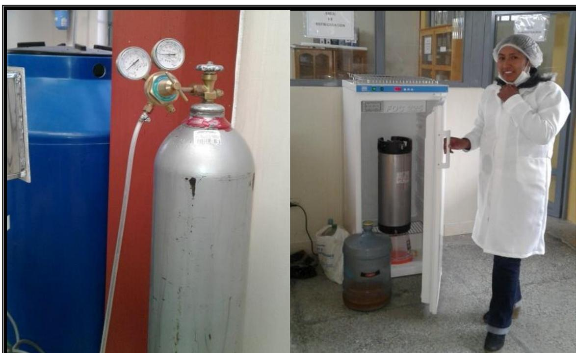
**DESCRIPCION:** En las fotos se muestra el tanque de alta presión de 200psi donde se realizó el gasificado o carbonatación para su posterior refrigerado.
