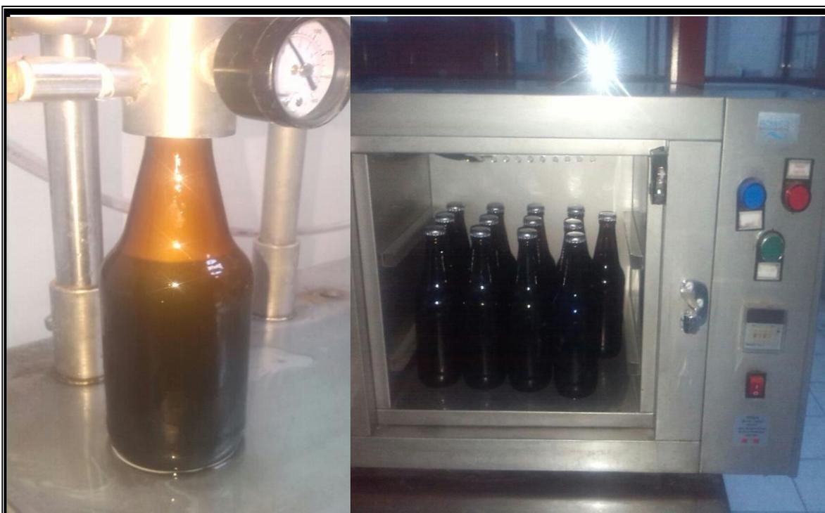
**DESCRIPCION:** se observa el enchapado respectivo para evitar la pérdida de CO<sub>2</sub> y luego se pasa a esterilizar con rayos ultravioleta.
