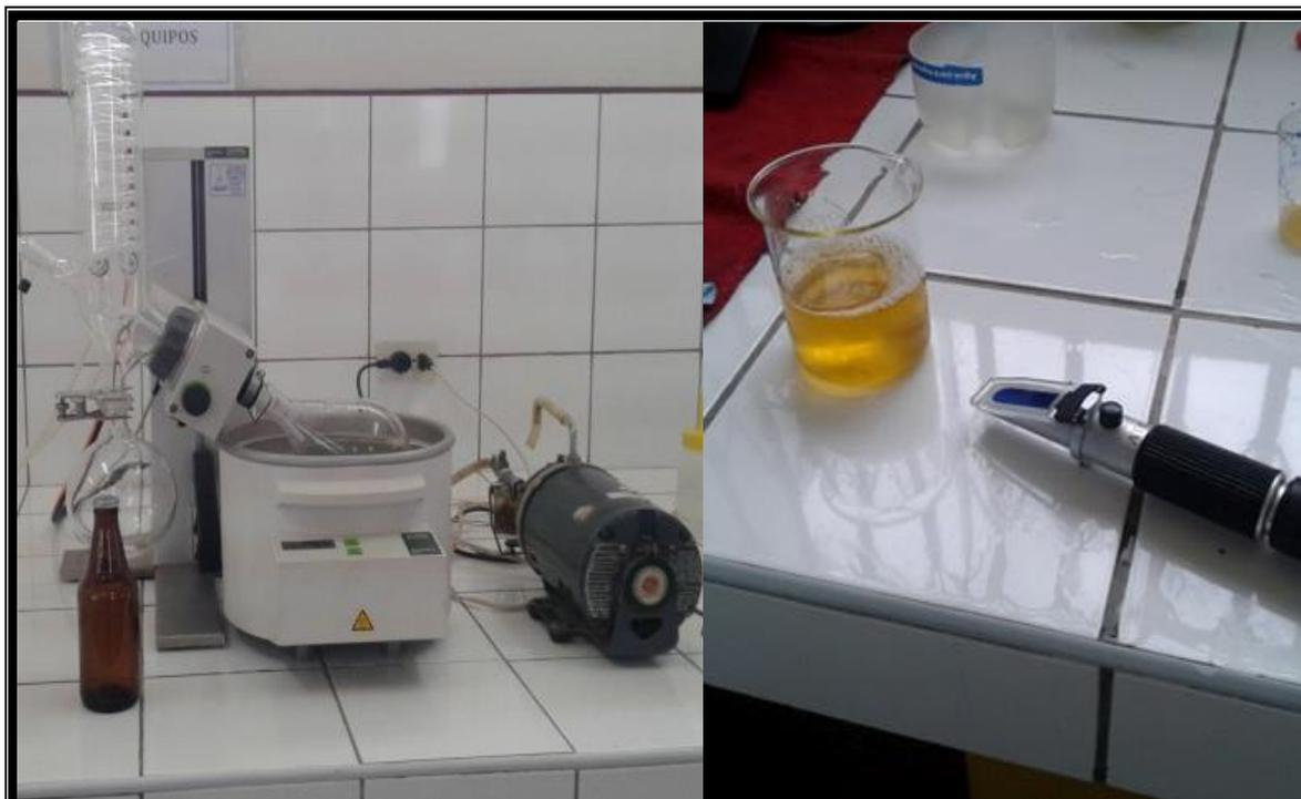
**DESCRIPCION:** Se muestra el alcoholímetro gay Lussac que sirve para medir los grados de alcohol que tiene la cerveza y a su vez se muestra el refractómetro para el control de °Brix.
