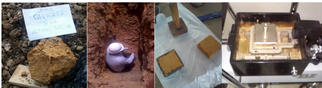
Figura 97 Fotos de la extracción de muestra y ensayos de laboratorio.
