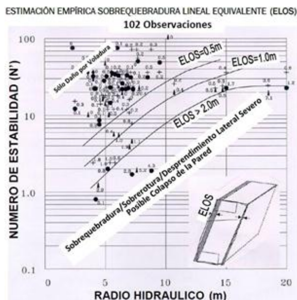
Figura 4.36: Estimación empírica para el desprendimiento de las cajas (ELOS), (Pakalnis, 2008).
