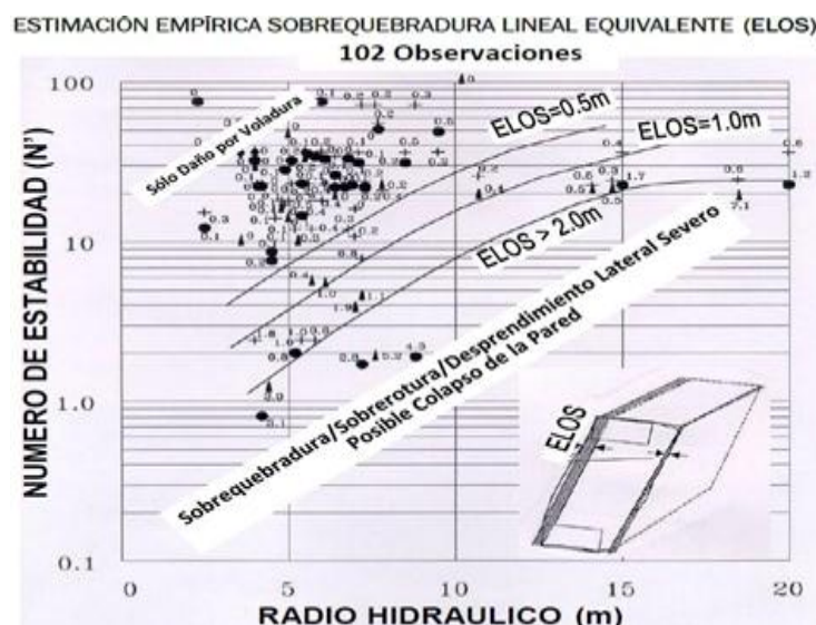
Figura 2.12: Estimación empírica para el desprendimiento de las cajas ELOS (Pakalnis, 2008).
