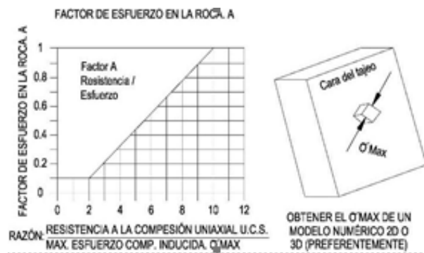
Figura 4.31: Factor de esfuerzo en la roca “A” (Potvin, 1988).
