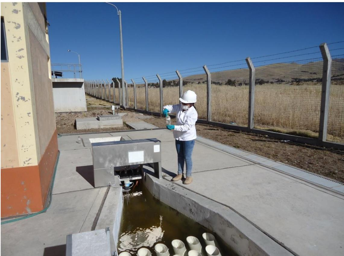
**ENVASADO DE LA MUESTRA DEL EFLUENTE DE LA PTAR YUNGUYO**
