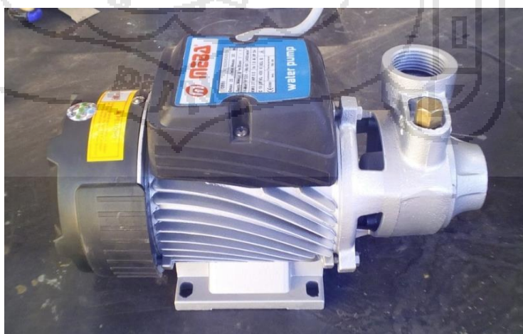
Figura 52. Electrobomba Centrífuga Trifásica. Fuente: Elaboración propia
