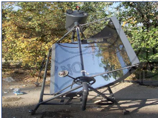
Figura 16. Concentrador Solar. Fuente: (Yilmaz et al., 2017)
