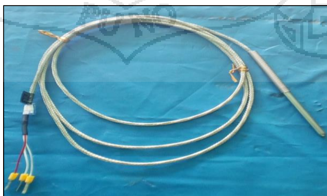
Figura 50. Sonda de Temperatura PT-100. Fuente: Elaboración propia
