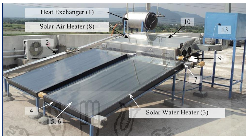
Figura 17. Colector Solar Plano. Fuente: (Velmurugan et al., 2016)
