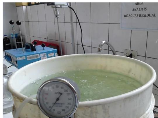
b) Control Presión con Manómetro
