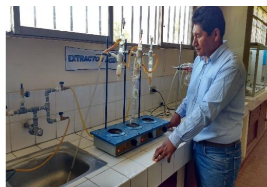
Figura 29. Método de extracción de grasa por Soxhlet
