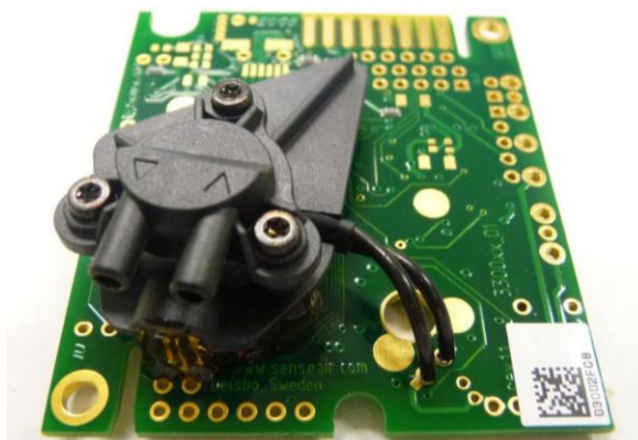
Figura 16. Sensor de CO 2 30% K-33 ICB
