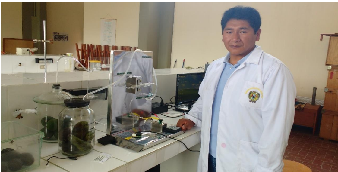
Figura 32. Sistema automatizado de monitoreo y control de la tasa respiratoria para frutas en postcosecha
