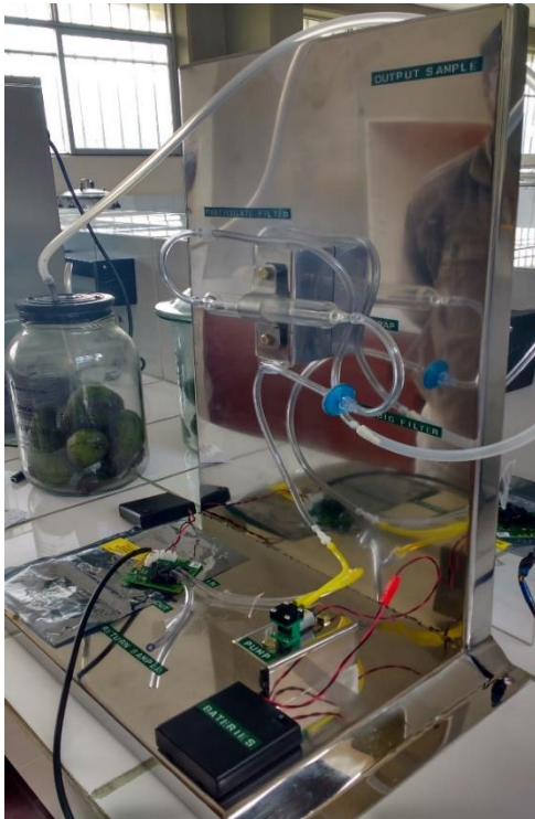
Figura 30. Panel de componentes: (cámara de respiración de 0.005m 3 , sensor de CO 2 , filtros de partículas e hidrofóbico, trampa de agua y bomba)
