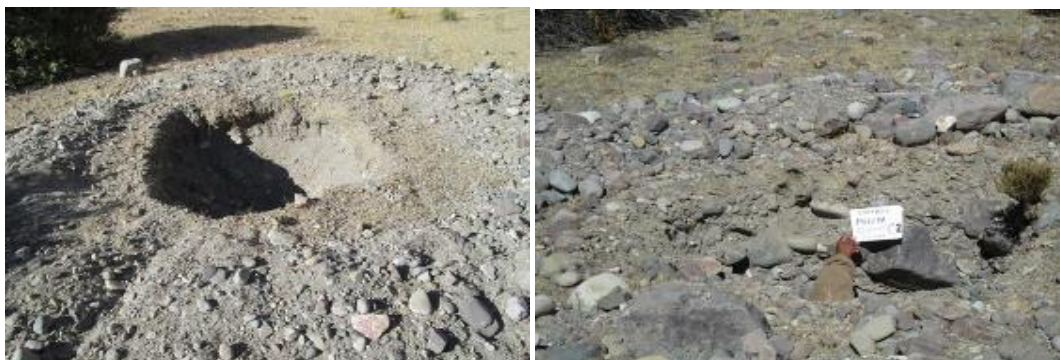
Imagen 28 APERTURA DE CALICATAS EN RIO CORALAUQUE
