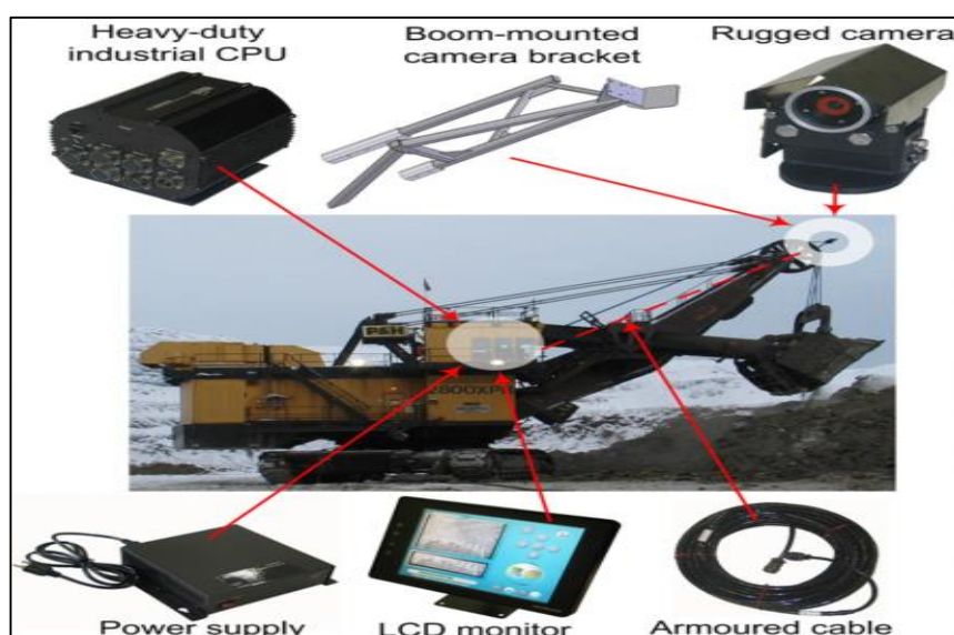
Figura 2.1. Instalación de la cámara en la pluma de la pala.
