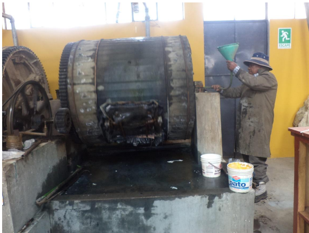
Figura N° 08. Piquelado de pieles ovinas
