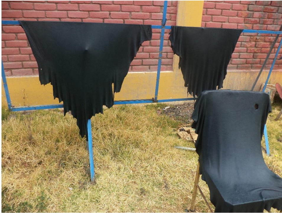
Figura N° 13. Secado de pieles ovinas.
