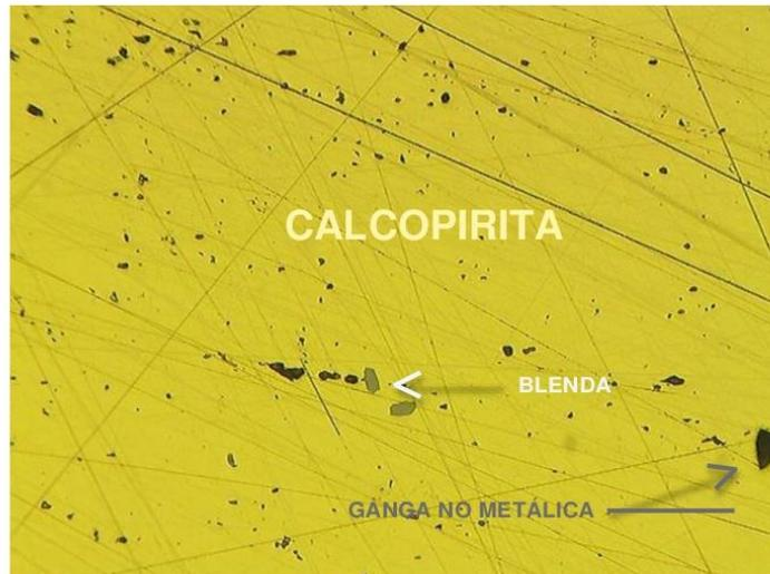
FOTOGRAFÍA N° 1. Escala: 1 cm=50  $\mu$ m Vista general de la zona de la Calcopirita.
