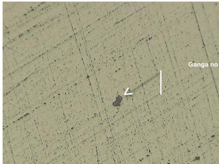
FOTOGRAFÍA N° 5. Escala: 1 cm=50  $\mu$ m. Ganga no metálica incluida en la Pirita
