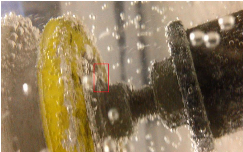
Figura 4.36 Formación de burbujas en la extremidad inferior del pararrayos de carcasa cerámica.
