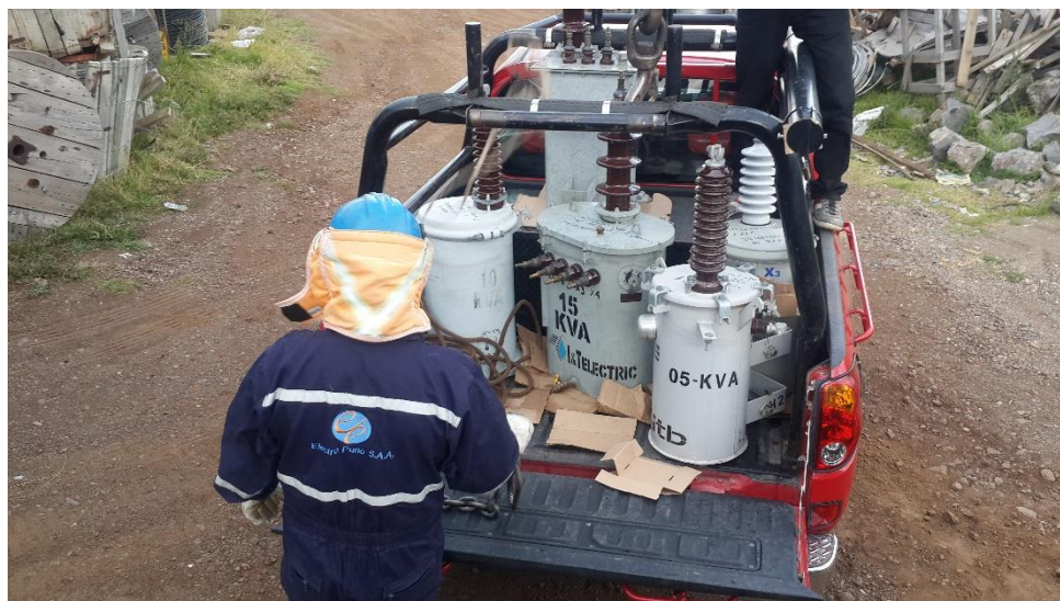
Figura 2.1 Transporte de transformadores de distribución con cubierta polimerica averiados.
