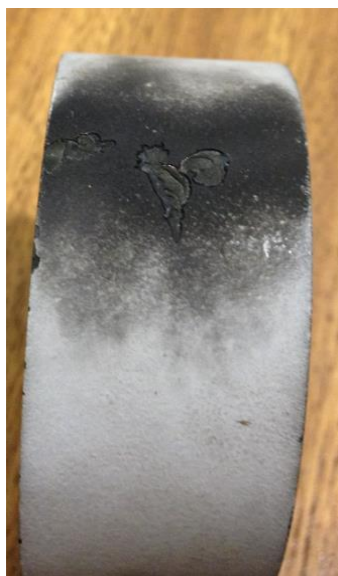
Figura 3.3 Puntos de carbonización de la cinta aislante que envuelve el bloque de ZnO.
