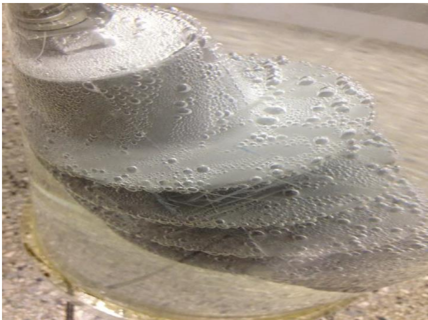
Figura 4.33 Formación de burbujas en el pararrayos nuevo.
