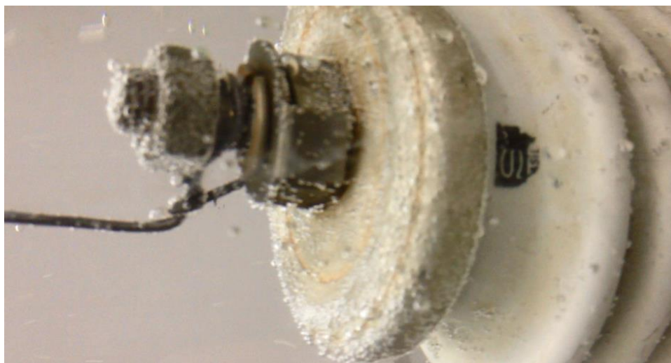
Figura 4.35 Formación de burbujas en la extremidad superior del pararrayos de carcasa cerámica.
