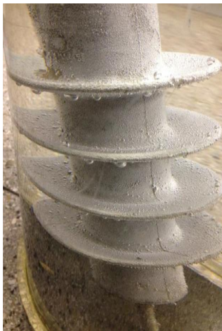
Figura 4.27 Formación de burbujas en la carcasa polimérica.
